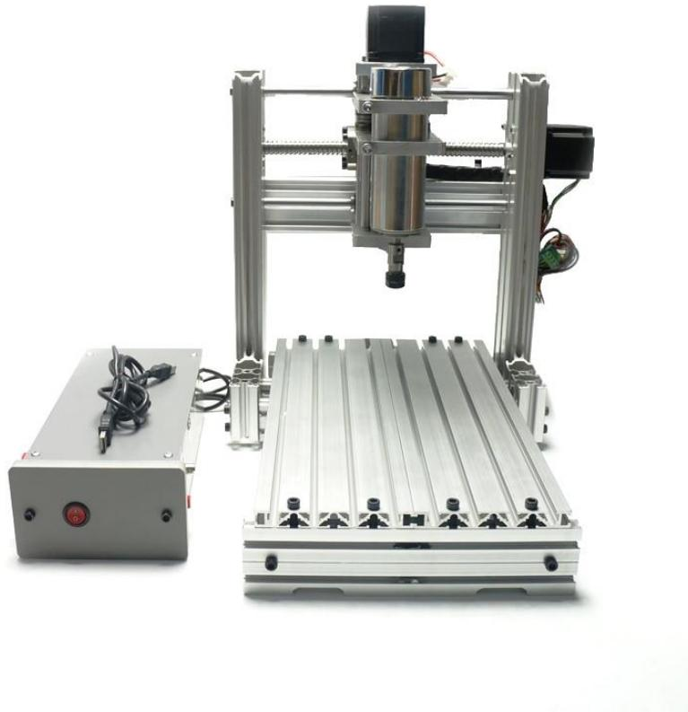
**Slika 2 CNC usmjerivač**
