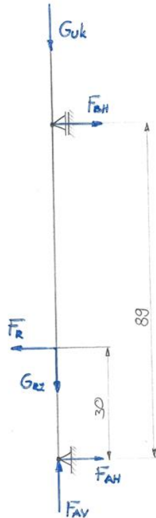
Slika 16 Proračunski model vratila
