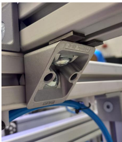
Slika 30. Pločice postavljene između kutnika i profila
