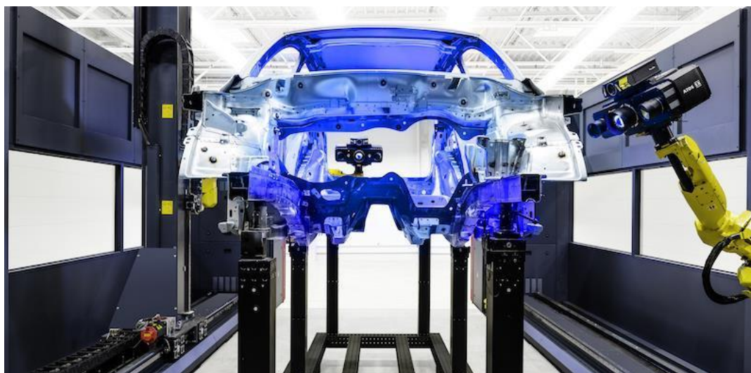
Slika 6. Kontrola karoserije ATOS 5X mjernim sustavom [11]
