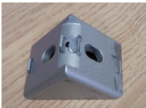
Slika 28. Kutnik nakon brušenja
