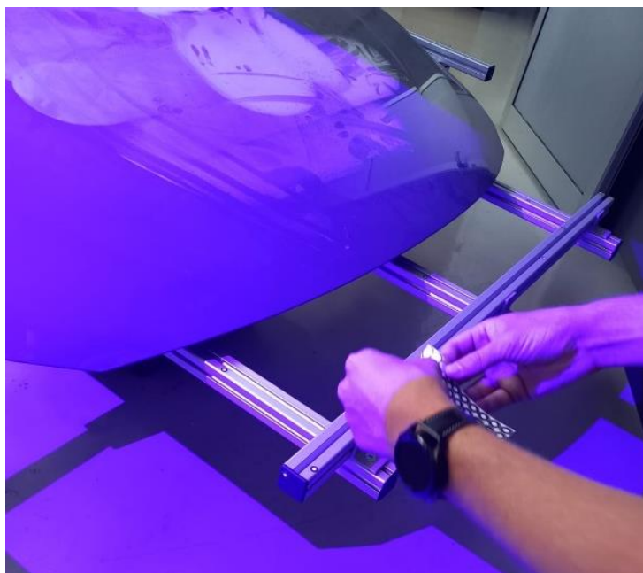
Slika 11 Postavljanje markera na steznu napravu
