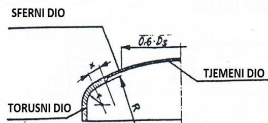
Slika 4.Podnica s različitim debljinama stijenke torusnog i cilindričnog dijela
