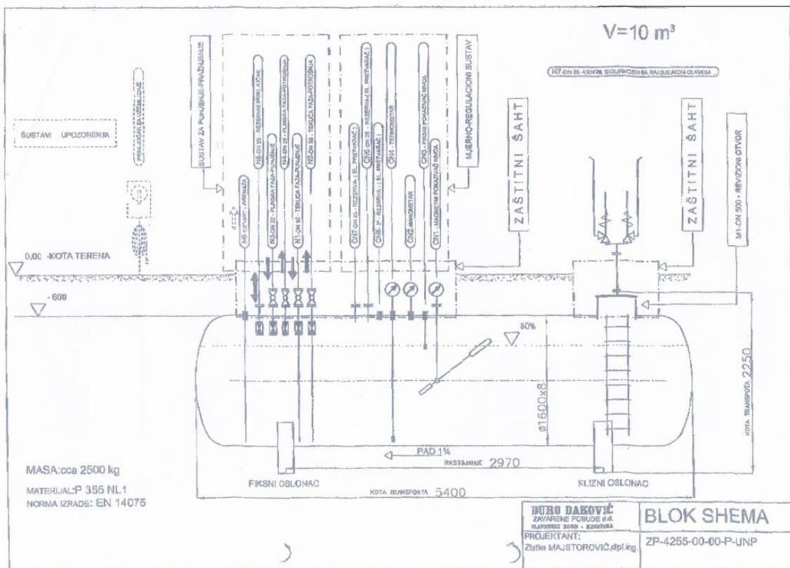
Slika 5.Blok shema spremnika za UNP volumena  $10 m^3$ ,
