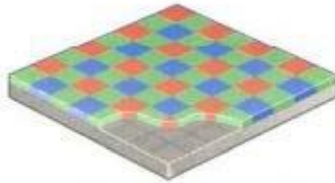
Slika 4 – Filterska mreža ispred senzora [5]
