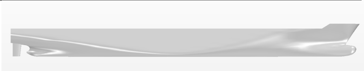
Slika 10. 3D model 6750-TEU kontejnerskog broda
