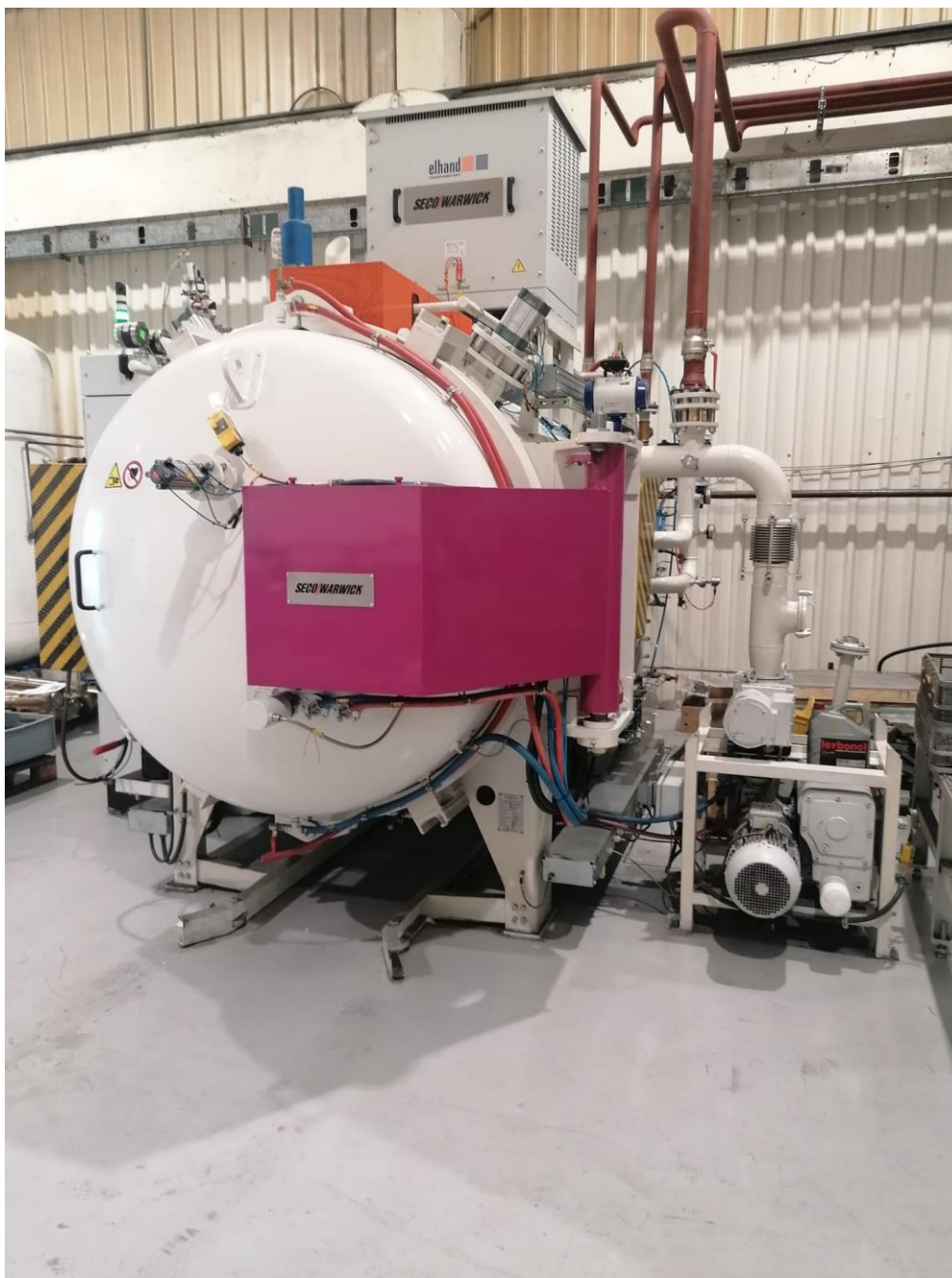
Slika 25. Vakuumska peć u Centru toplinske obrade d.o.o.
