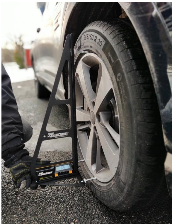
Slika 4.4. Primjena uređaja za mjerenje nagiba s inklinometrom
