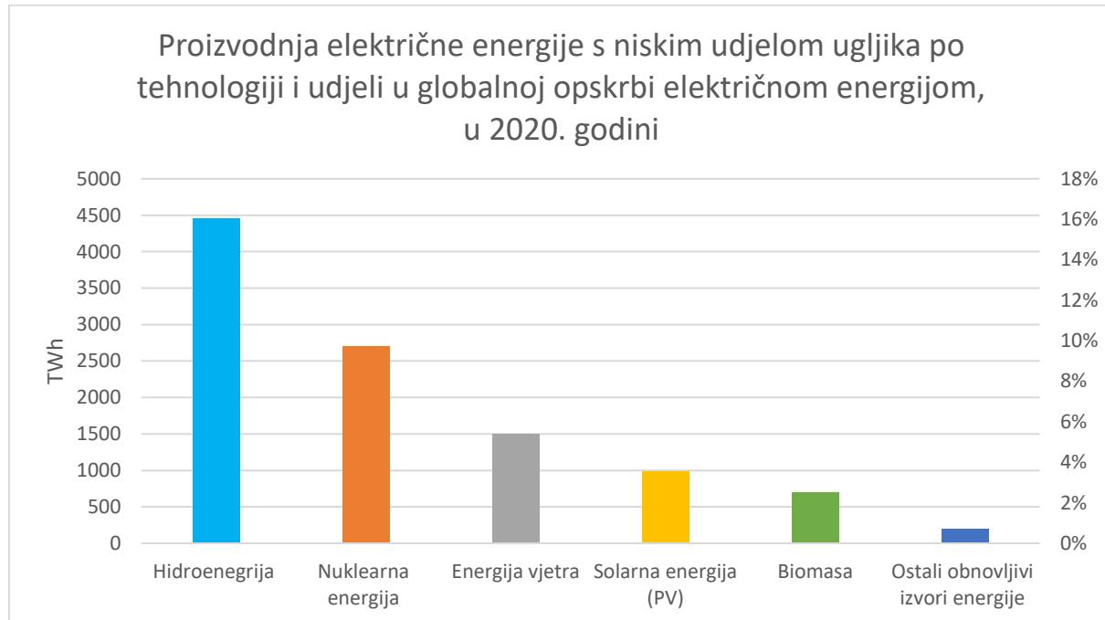
Graf 2. Proizvodnja električne energije s niskim udjelom ugljika po tehnologiji i udjeli u globalnoj opskrbi električnom energijom, u 2020. godini [11]
