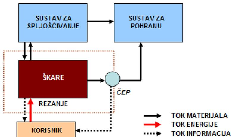
Slika 18. Shematski prikaz sustava za odvajanje čepa
