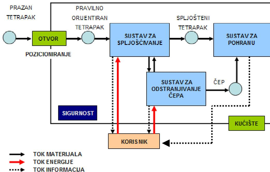
Slika 16. Shematski prikaz uređaja za odlaganje višekomponentnog papira
