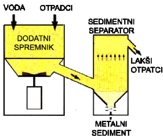
Slika 11. Prikaz sedimentacijskog separatora s dodatnim spremnikom [21]
