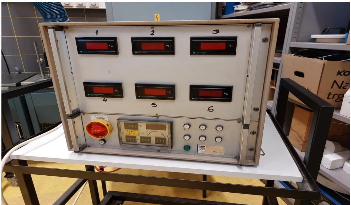
**Slika 19. Termometrijski most umjeravanih termometara nepoznatog proizvođača**
