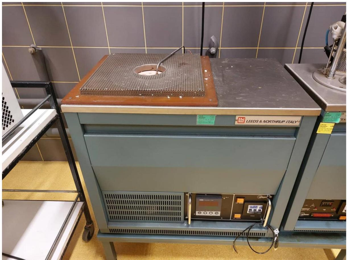
**Slika 17. Termometrijska peć proizvođača Leeds&Northrup**
