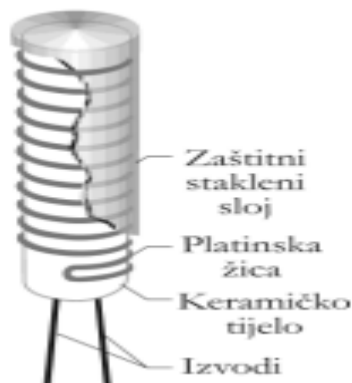
Slika 6. Prikaz izvedbe osjetnika temperature s platinskom zavojnicom
