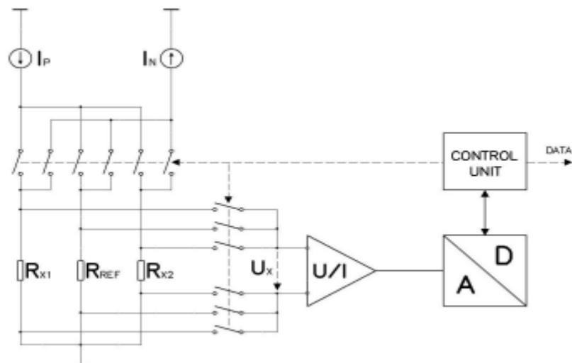
**Slika 15. Fotografija termometrijskog otporničkog mosta EOMOS02 (gore), Shematski prikaz sklopoljja mosta (dolje)**
