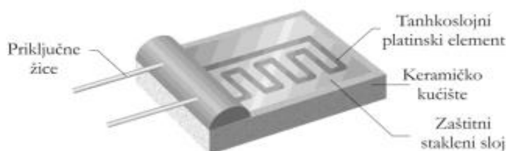
Slika 5. Prikaz izvedbe pločastog platinskog osjetnika temperature
