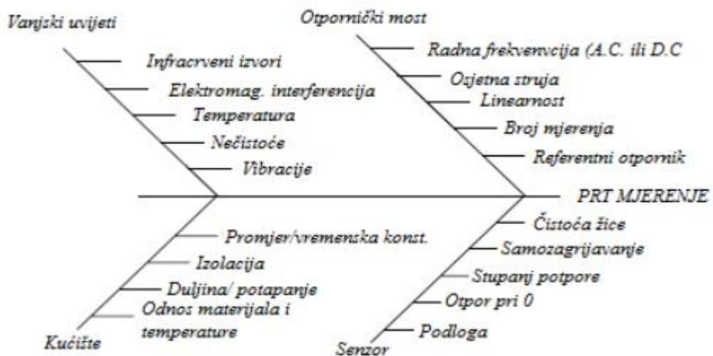
**Slika 10. Mogući izvori pogrešaka pri mjerenuju temperaturom otporničkim termometrima**
