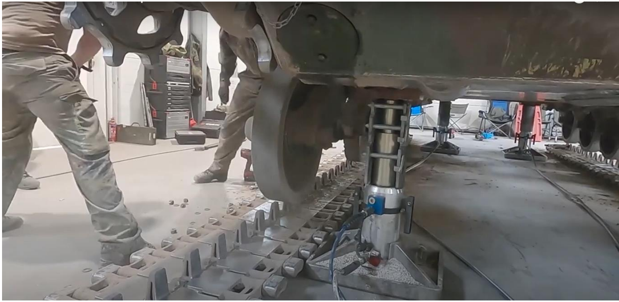
Slika 23. Zamjena potpornog kotača na tenku Leopard 2, nizozemske vojske [15]
