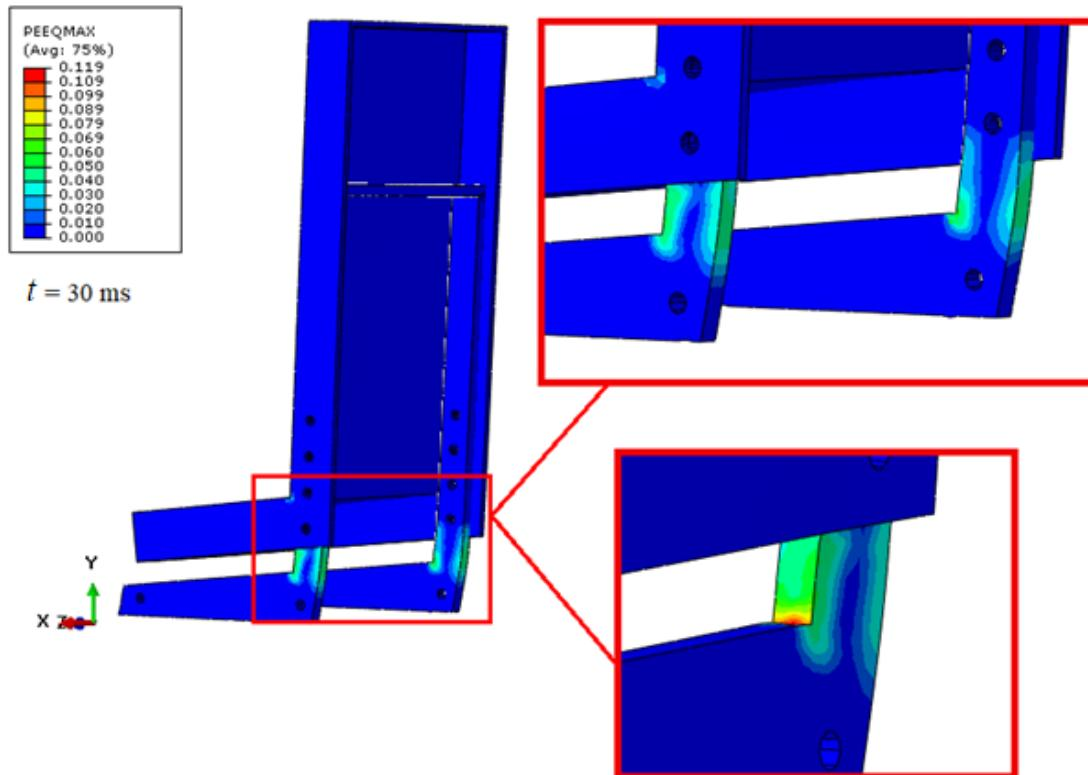
**Slika 34.** Ekvivalentne plastične deformacije [-] aluminijskog sjedala u trenutku 30 ms
