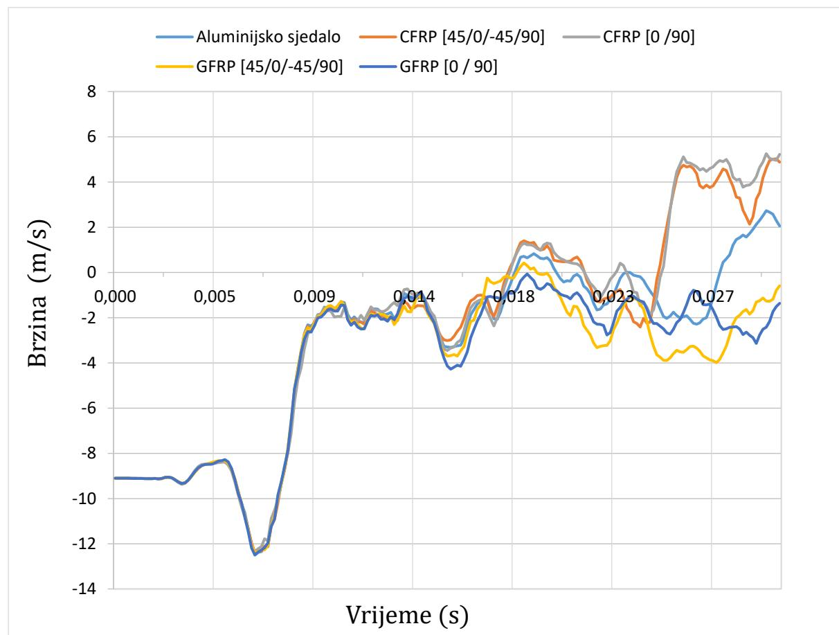
**Slika 57. Dijagram brzine (m/s) u ovisnosti o vremenu za sve ispitane modele**
