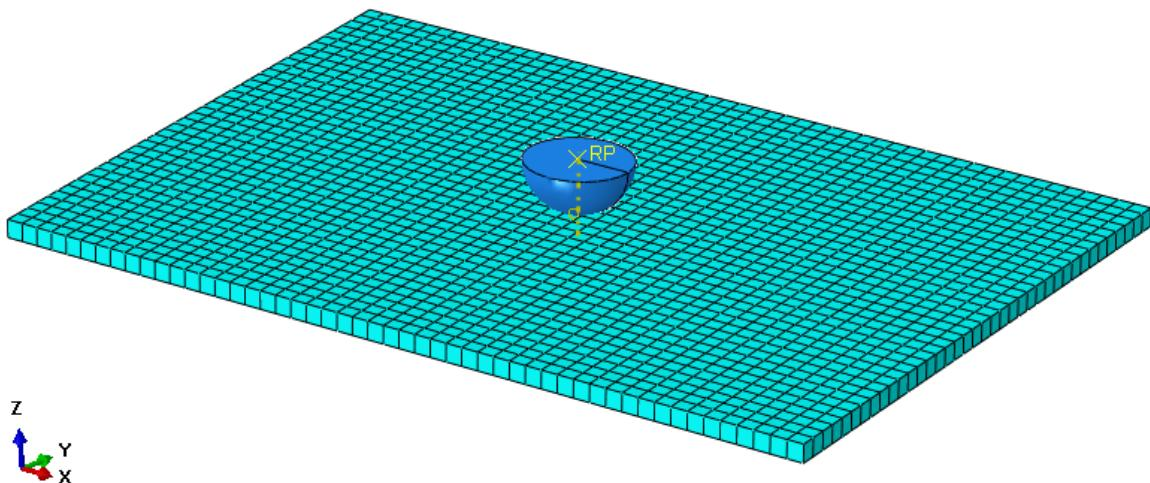
**Slika 23. Prikaz diskretiziranog cijelog modela kontinuumskim ljkastim konačnim elementima**
