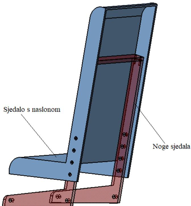
**Slika 10. Prikaz konstrukcije modela sjedala bez prigušnog mehanizma**
