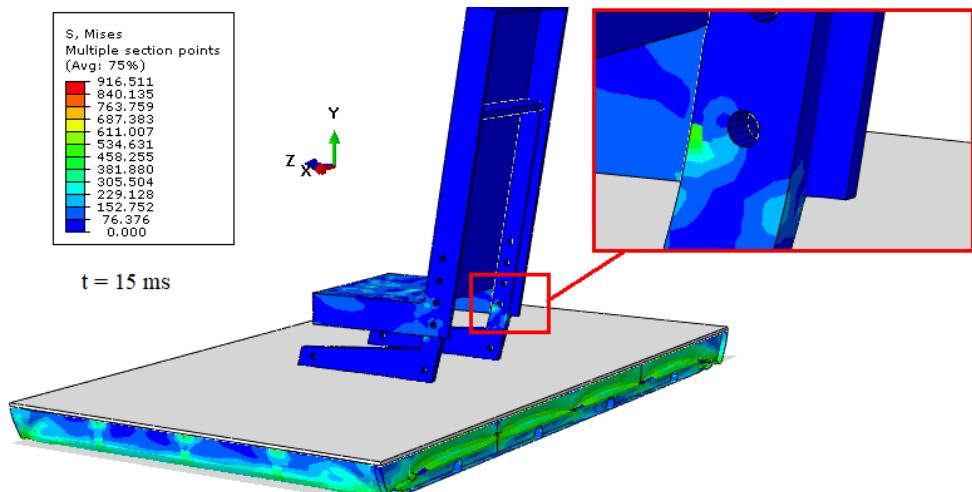
**Slika 37.** Ekvivalentno *von Mises* naprezanje GFRP materijala za orijentaciju vlakana [0/90]<sub>10</sub> za 15 ms [MPa]
