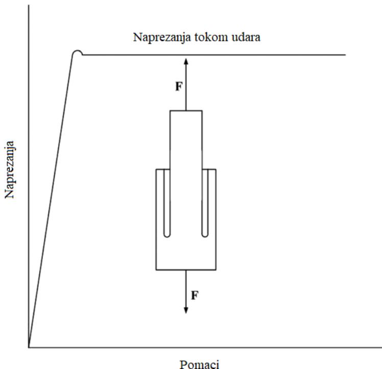
**Slika 5. Prikaz mehanizma za apsorpciju energije inverziske cijevi [12]**
