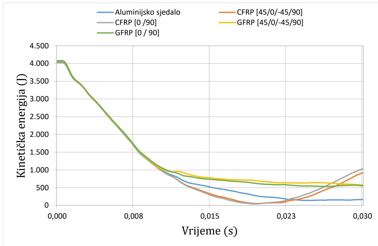
**Slika 53. Dijagram kinetičke energije [J] u ovisnosti o vremenu**
