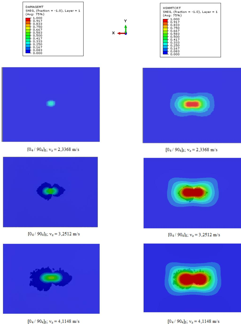
**Slika 43. Prikaz rezultata varijabli DAMAGE i HSNTCRT za model pojednostavljenje višeslojne kompozitne ploče pri različitim brzinama**
