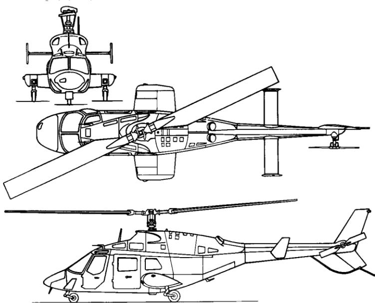
**Slika 3. Shematski prikaz Bell 222 helikoptera [11]**
