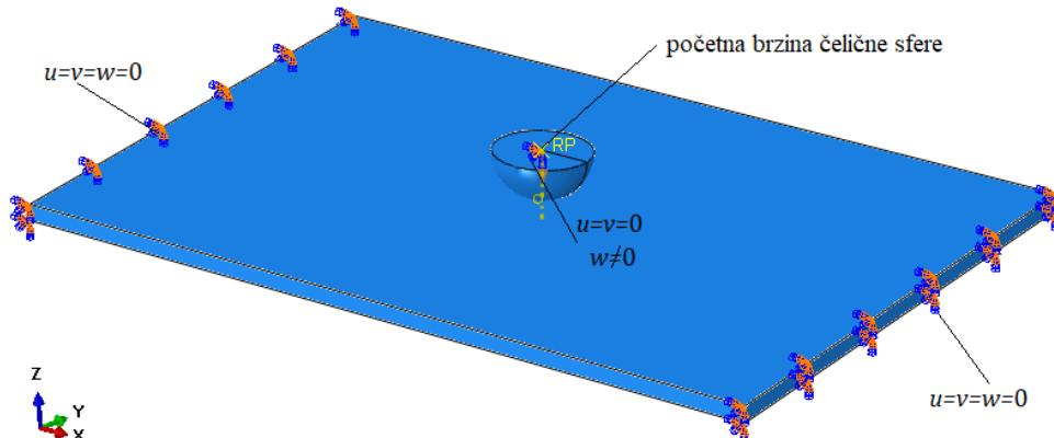
**Slika 22. Rubni uvjeti primjenjeni na pojednostavljenu višeslojnu kompozitnu ploču**
