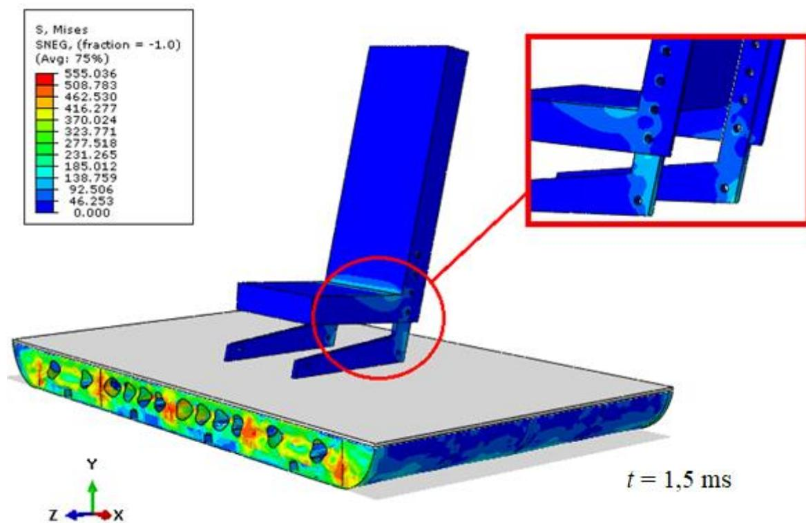
**Slika 25.** Ekvivalentno *von Mises* naprezanje aluminijskog sjedala u trenutku 1,5 ms [MPa]
