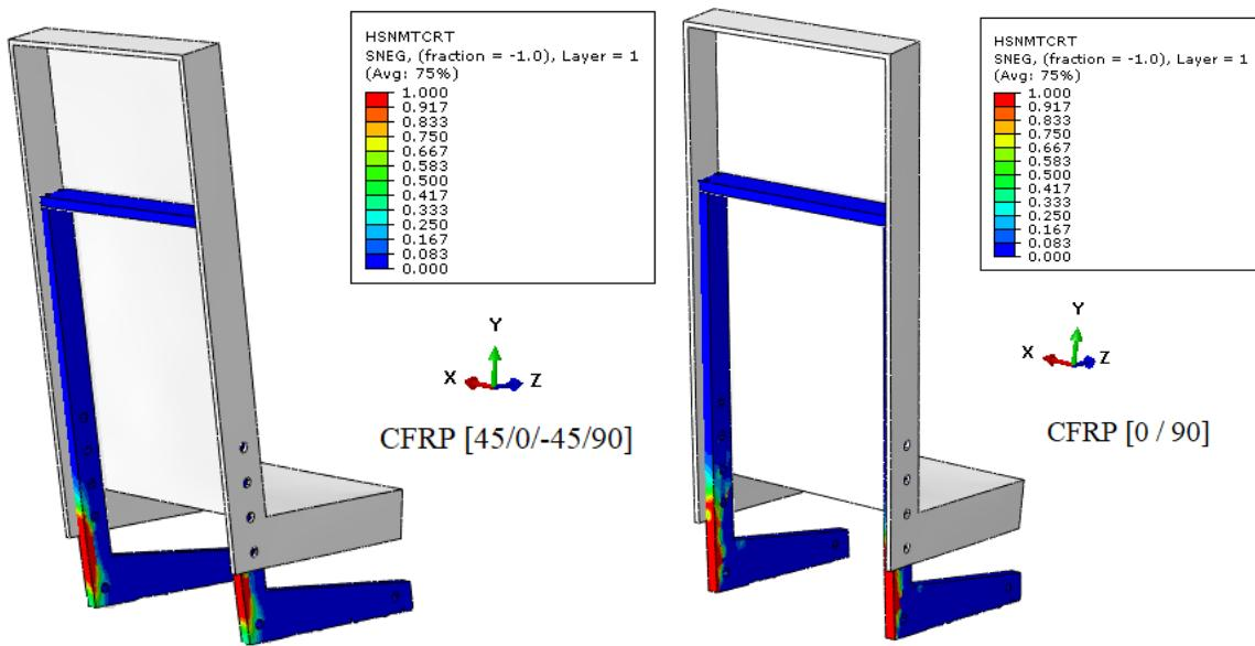
Slika 47. Usporedba HSNMTCRT rezultata [-] koji se javljaju na sjedalu s CFRP s dvije različite orijentacije vlakna
