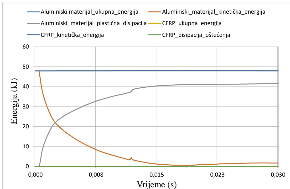
Slika 58. Usporedba energija za numeričku analizu cijelog modela
