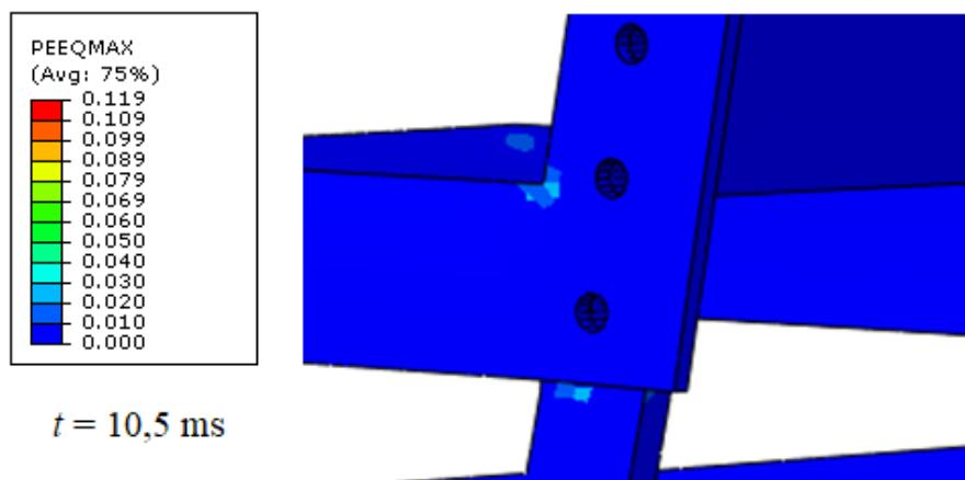
Slika 32. Ekvivalentne plastične deformacije [-] aluminijskog sjedala u trenutku 10,5 ms
