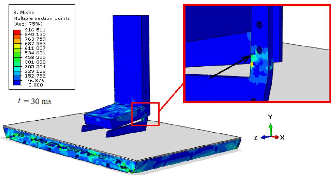
**Slika 38. Ekvivalentno *von Mises* naprezanje GFRP materijala za orijentaciju vlakana  $[0/90]_{10}$  za  $30 \text{ ms}$  [MPa]**
