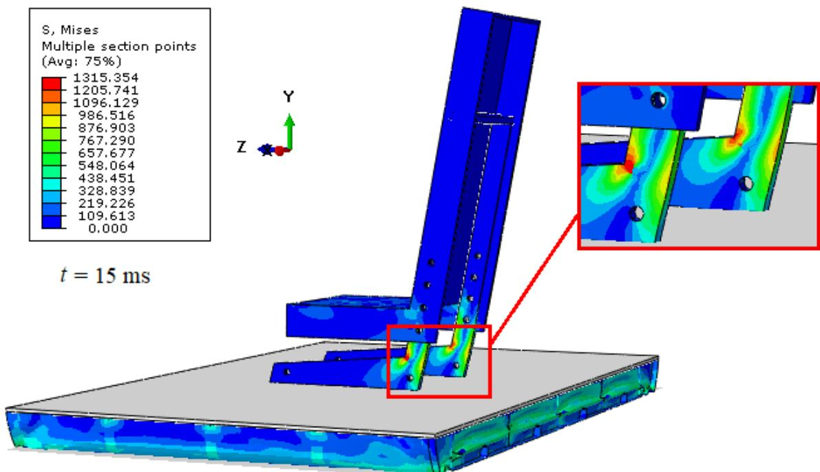
**Slika 39. Ekvivalentno *von Mises* naprezanje CFRP materijala za orijentaciju vlakana iz (24) za  $15 \text{ ms}$  [MPa]**
