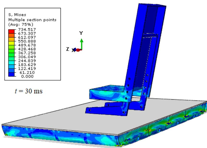
**Slika 42.** Ekvivalentno *von Mises* naprezanje za orijentaciju vlakana [0/90]<sub>10</sub> za 30 ms [MPa]
