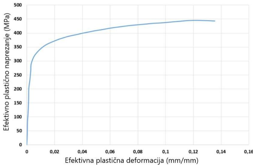
Slika 15. Dijagram efektivnih plastičnih deformacija i naprezanja [12]
