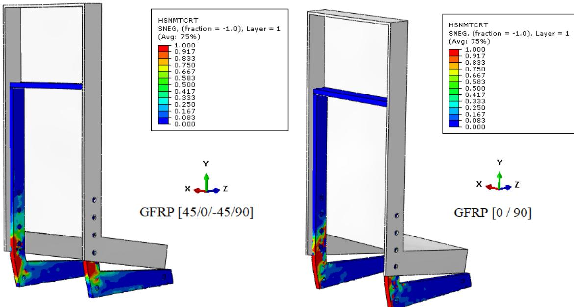
**Slika 50.** Usporedba HSNMTCRT rezultata [-] koji se javljaju na sjedalu s GFRP kompozitnim materijalom dvije različite orientacije vlakana
