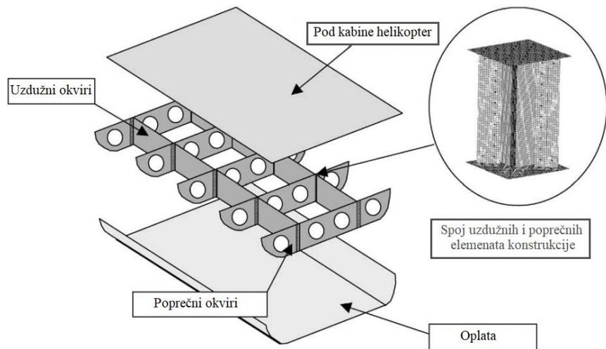
**Slika 2. Pojednostavljena konstrukcija poda helikoptera [4]**
