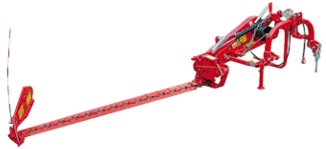
Slika 8. Oscilirajuća kosa s prstima Gaspardo montirana na trozglobnu hidrauličnu poteznicu [10]
