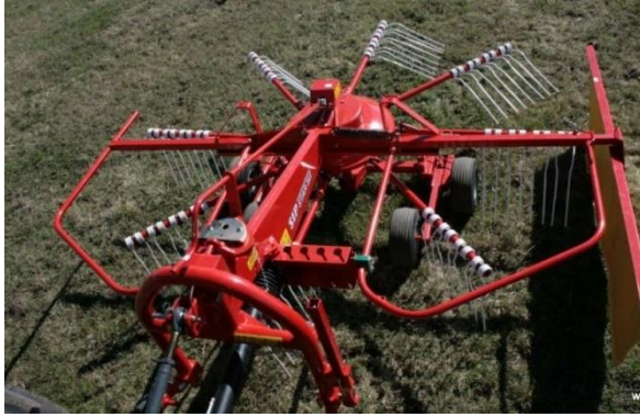
Slika 15. Rotacijske grablje proizvođača SIP [14]
