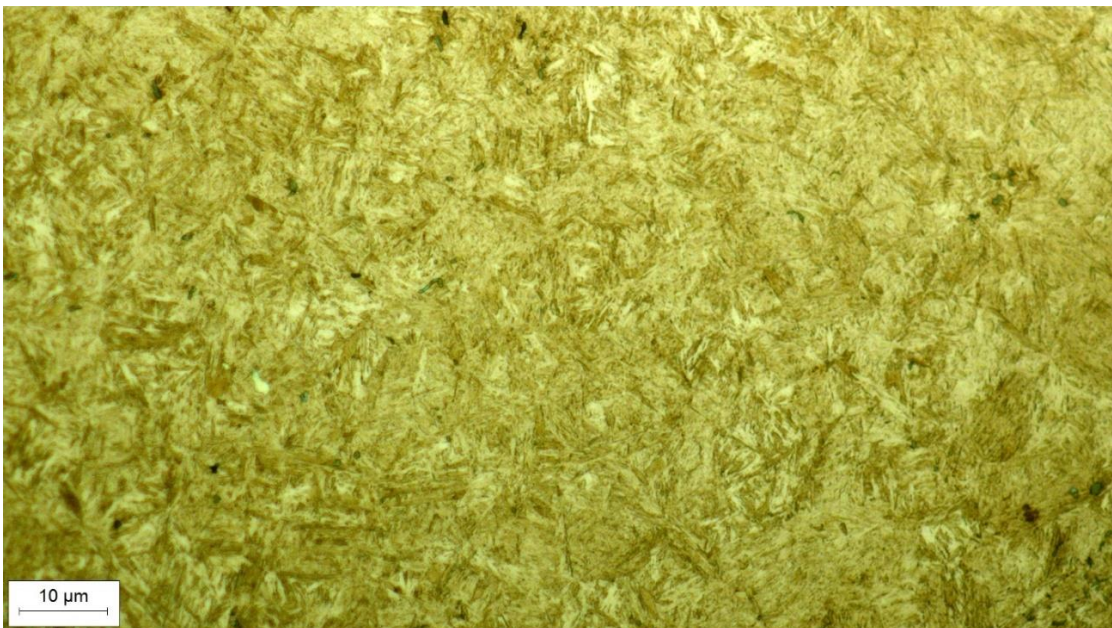
Slika 53. Mikrostruktura na rubu zuba-500x povećanje
