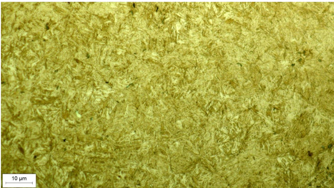
Slika 53. Mikrostruktura na rubu zuba-500x povećanje
