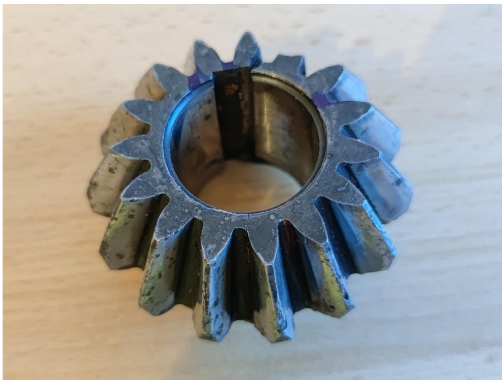
Slika 38. Tragovi trošenja ( pitting ) na cijelom obodu stožnika
