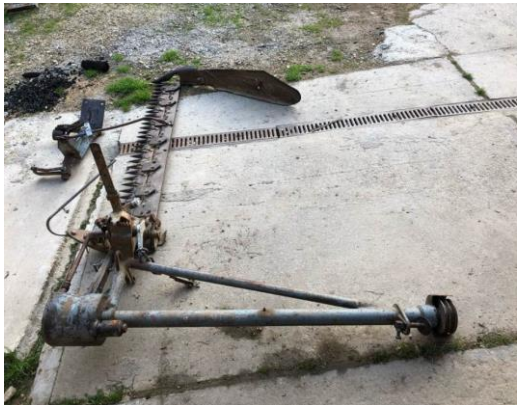
Slika 5. Oscilirajuća bočna kosa za traktor IMT 539 [9]
