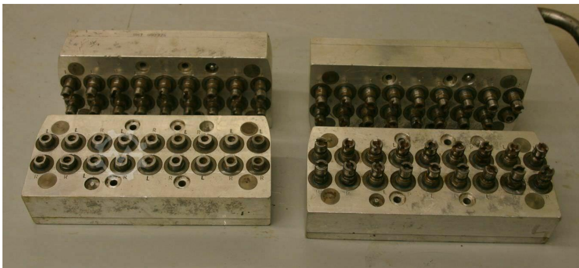
Slika 23. Primjer viševretene bušaće glave [19]
