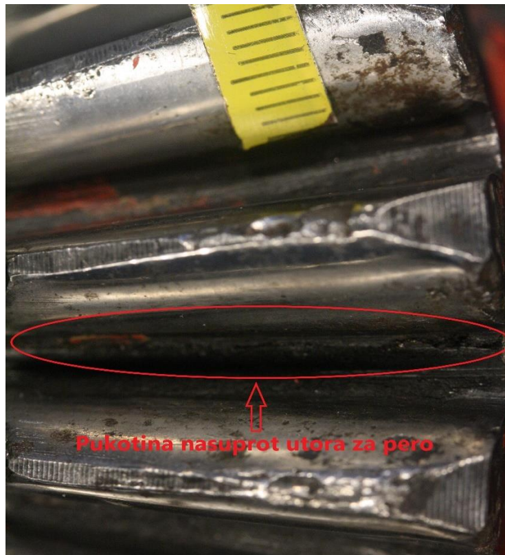
Slika 43. Pukotina nasuprot utora za pero-vanjska strana
