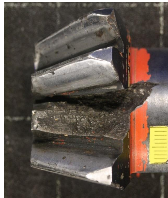
Slika 48. Izrezani dio s pukotinom i utorom za pero-vanjska strana
