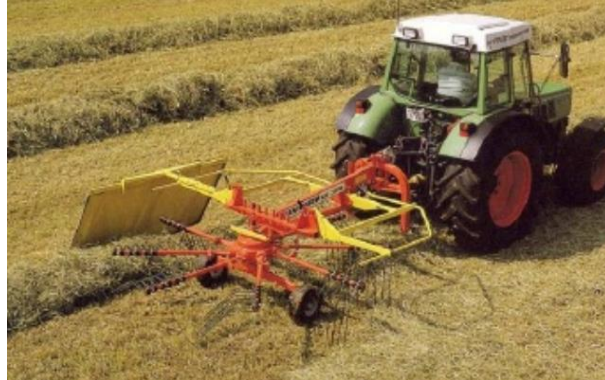
Slika 16. Rotacijske grablje proizvođača Claas [7]
