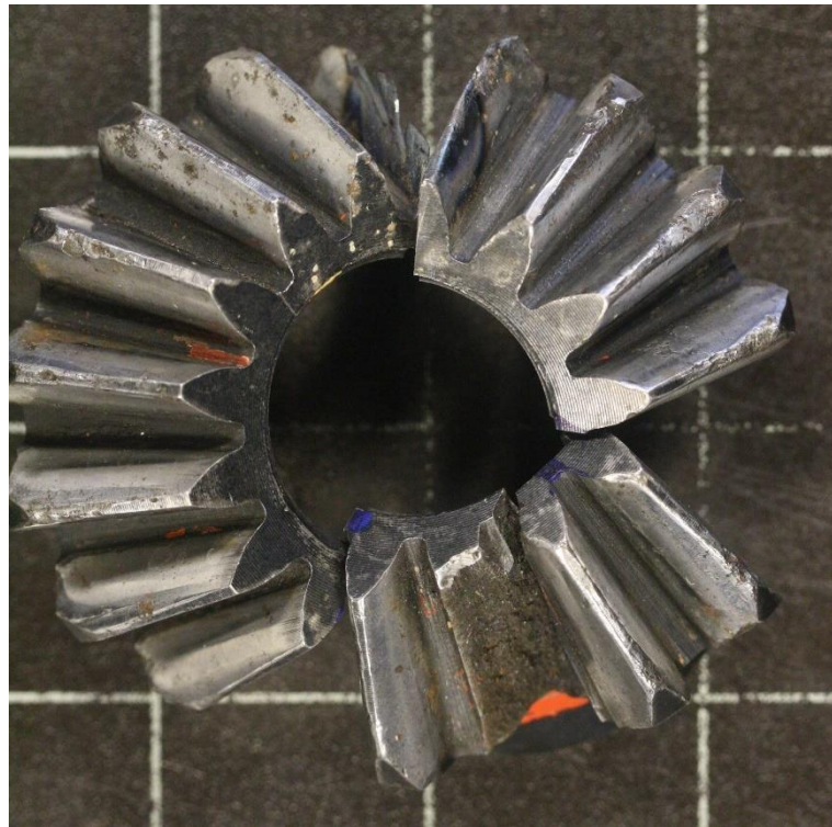
Slika 46. Izrezani dijelovi oštećenog stožnika
