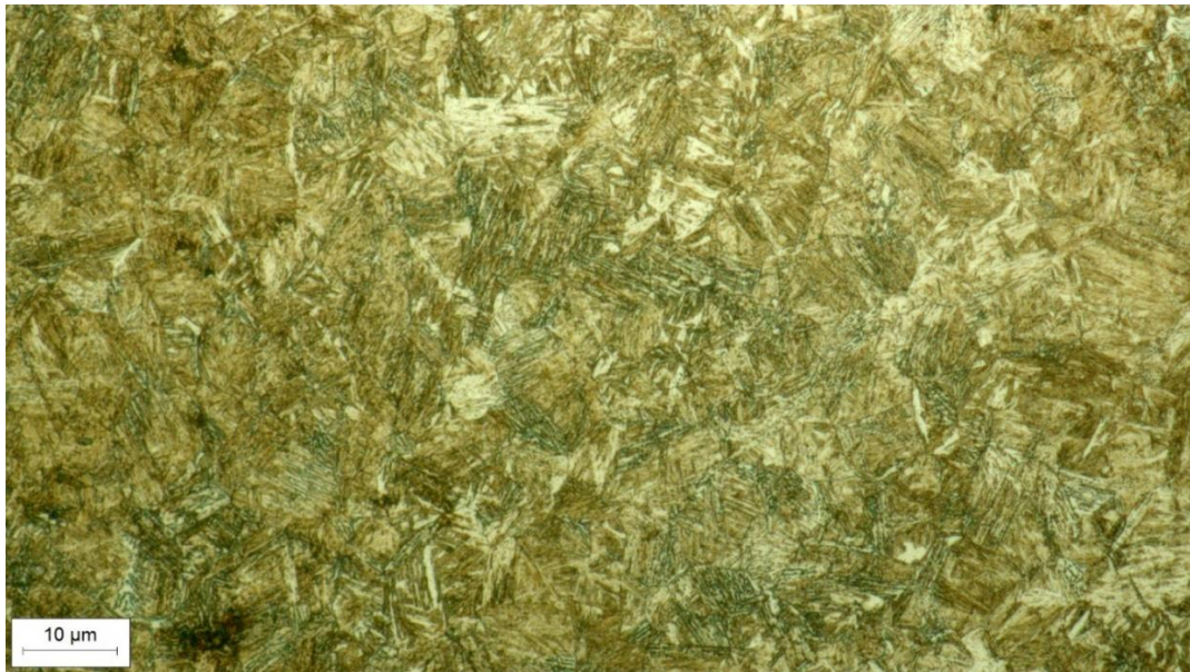
Slika 52. Mikrostruktura u jezgri stožnika-500x povećanje
