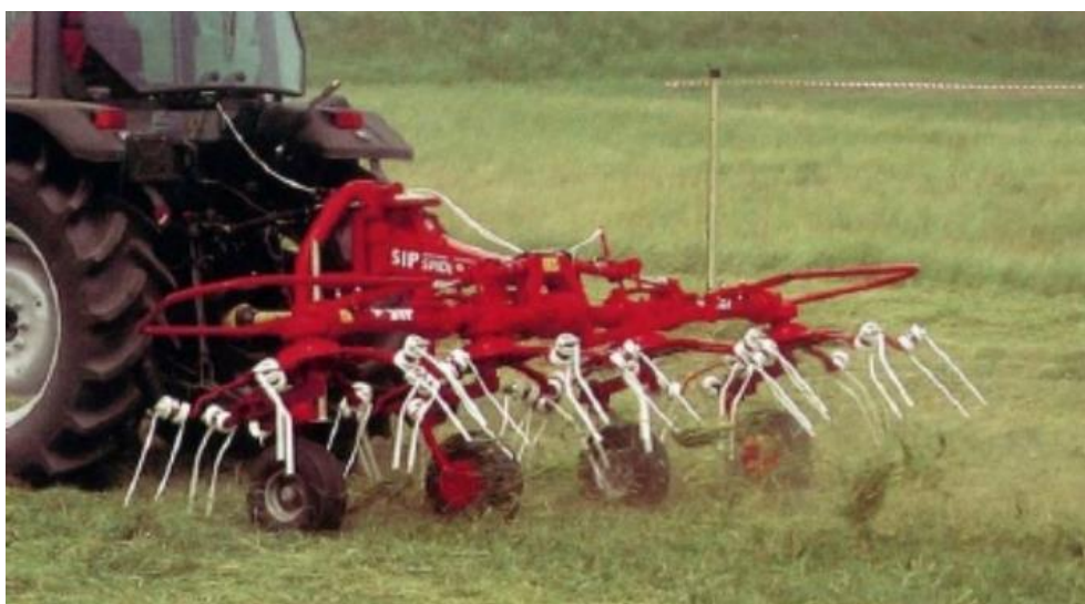
Slika 13. Rotacijski okretač-rastresač proizvođača SIP [7]
