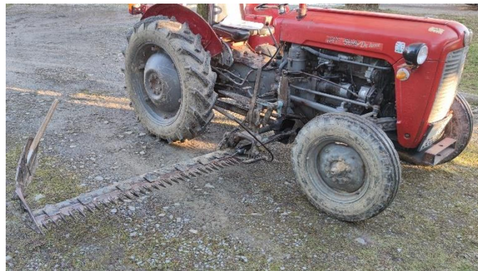
Slika 6. Oscilirajuća bočna kosa montirana na traktor IMT 539
