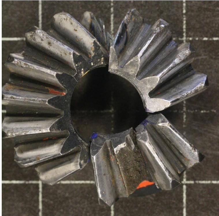
Slika 46. Izrezani dijelovi oštećenog stožnika
