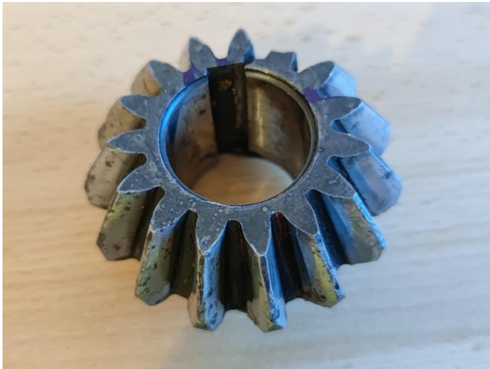
Slika 38. Tragovi trošenja ( pitting ) na cijelom obodu stožnika
