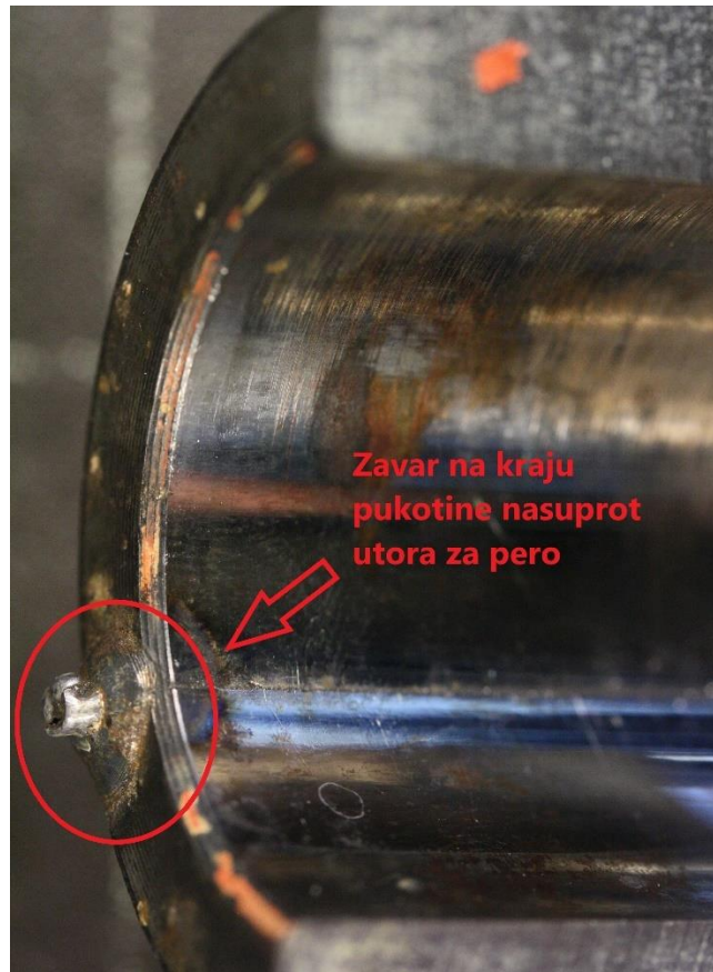
Slika 45. Zavar na kraju pukotine nasuprot utora za pero
