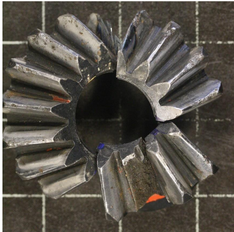
Slika 46. Izrezani dijelovi oštećenog stožnika
