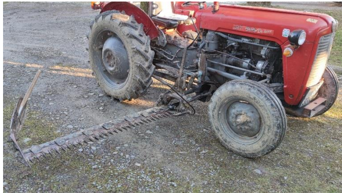
Slika 6. Oscilirajuća bočna kosa montirana na traktor IMT 539
