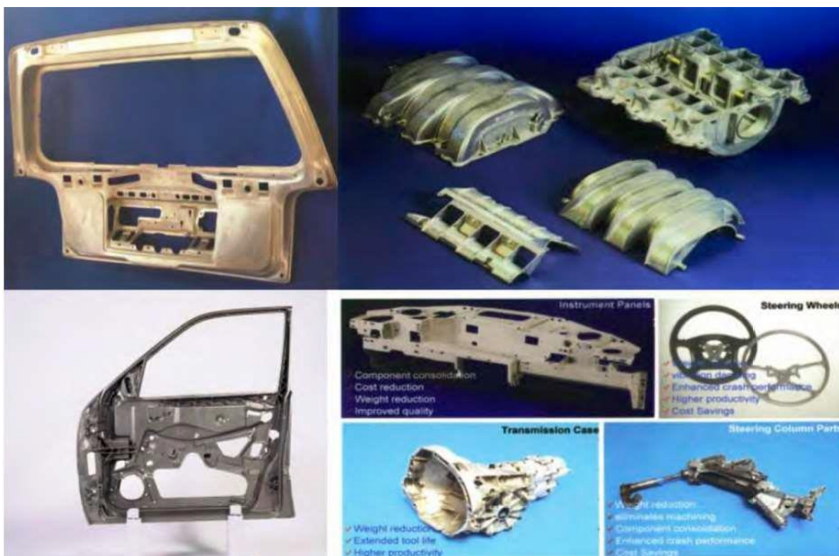
Slika 5. Tlačni lijev, odljevci od magnezijskih legura [2]
