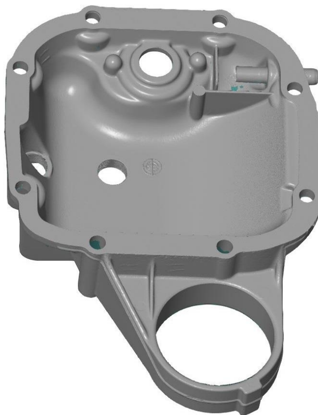
Slika 37. Spojeni model dobiven 3D skeniranjem – prednja strana
