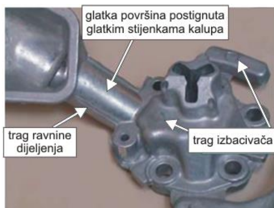
Slika 8. Geometrija odljevaka [7]
