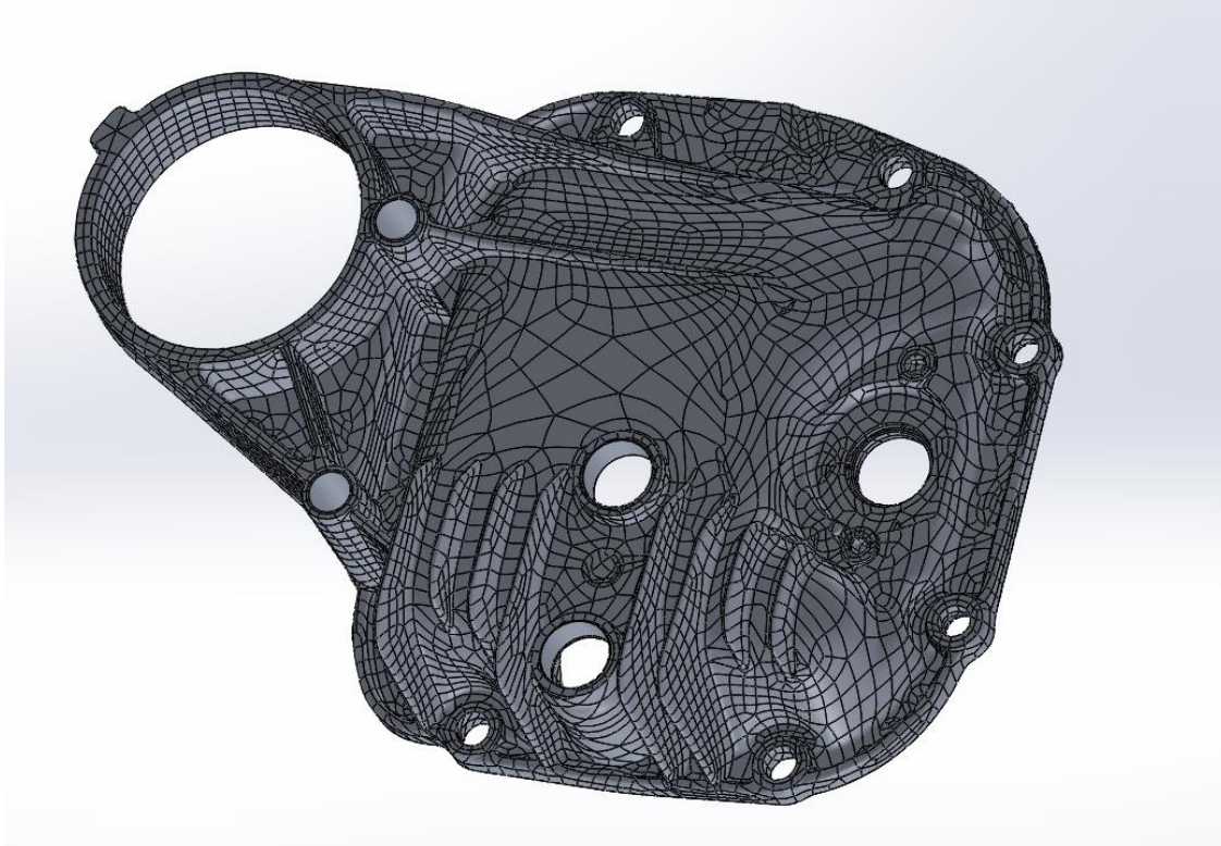
Slika 46. CAD model poklopca u Solidworksu
