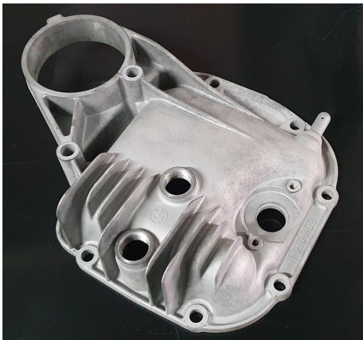
Slika 29. Pjeskareni poklopac korišten za 3D skeniranje
