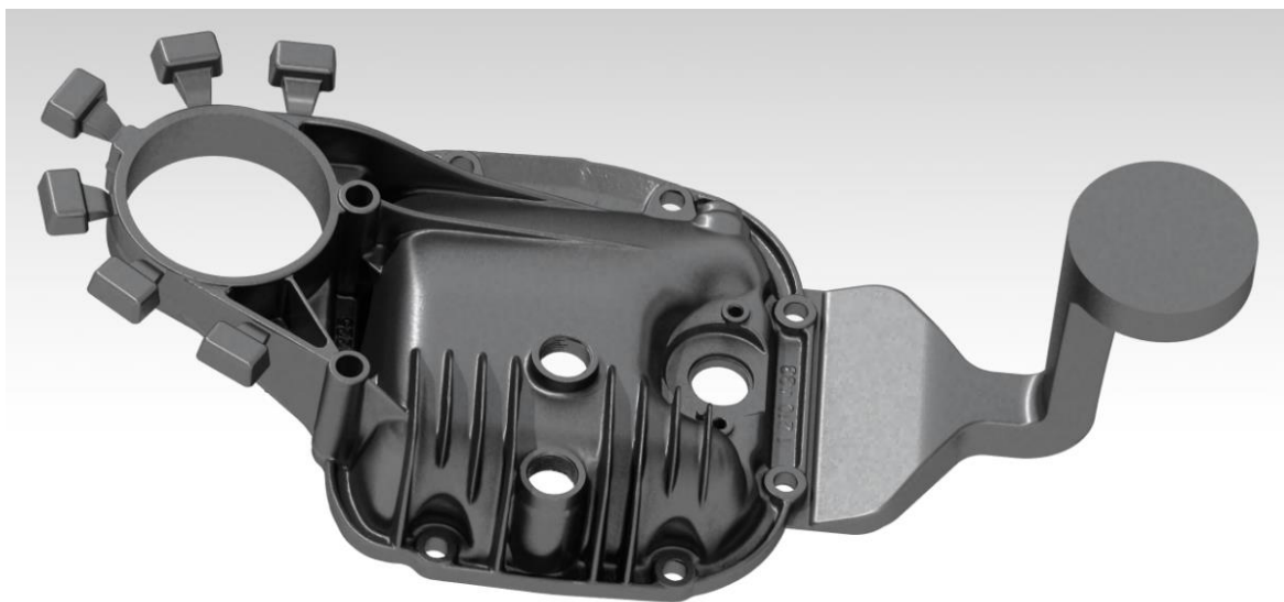
Slika 48. Renderirani CAD model sa sustavom za ulijevanje
