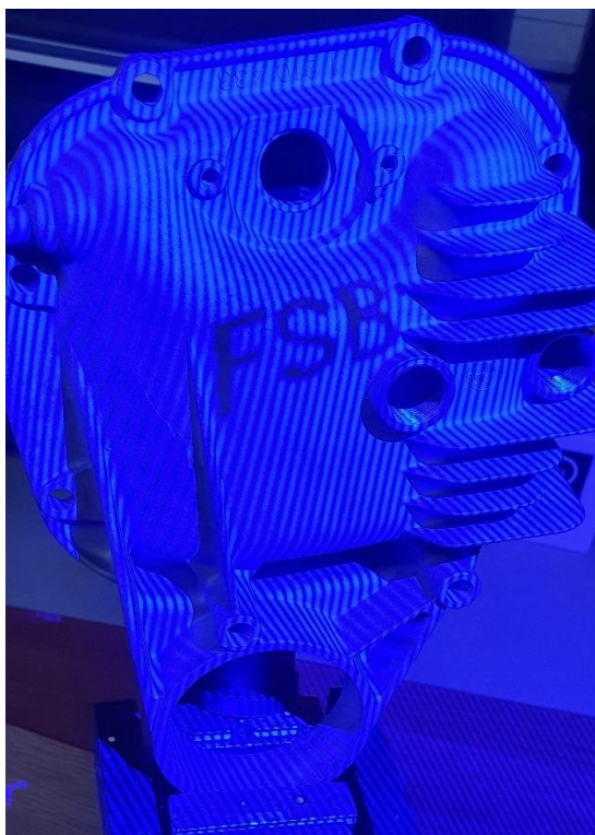
Slika 40. Parcijalno skeniranje – uzorak FSB
