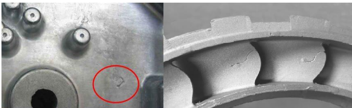
Slika 15. Hladni zavar u odljercima
