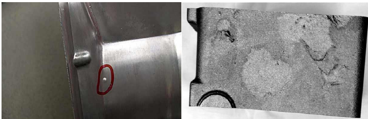
Slika 19. Ispupčenja u odljevcima [13][14]
