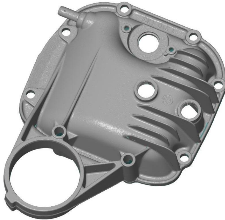
Slika 37. Spojeni model dobiven 3D skeniranjem – prednja strana
