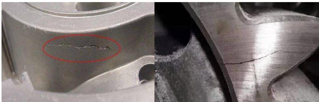
Slika 12. Pukotine u odljevcima [13][14]
