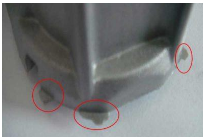
Slika 17. Rubni srhovi kod odljevka [13]
