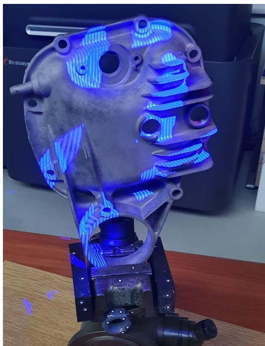
Slika 39. Parcijalno skeniranje površine
