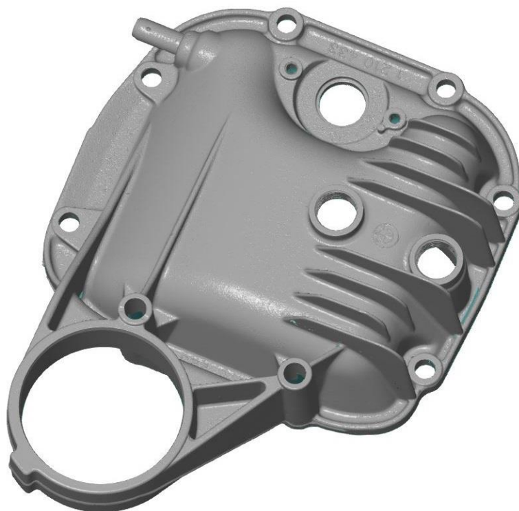
Slika 37. Spojeni model dobiven 3D skeniranjem – prednja strana
