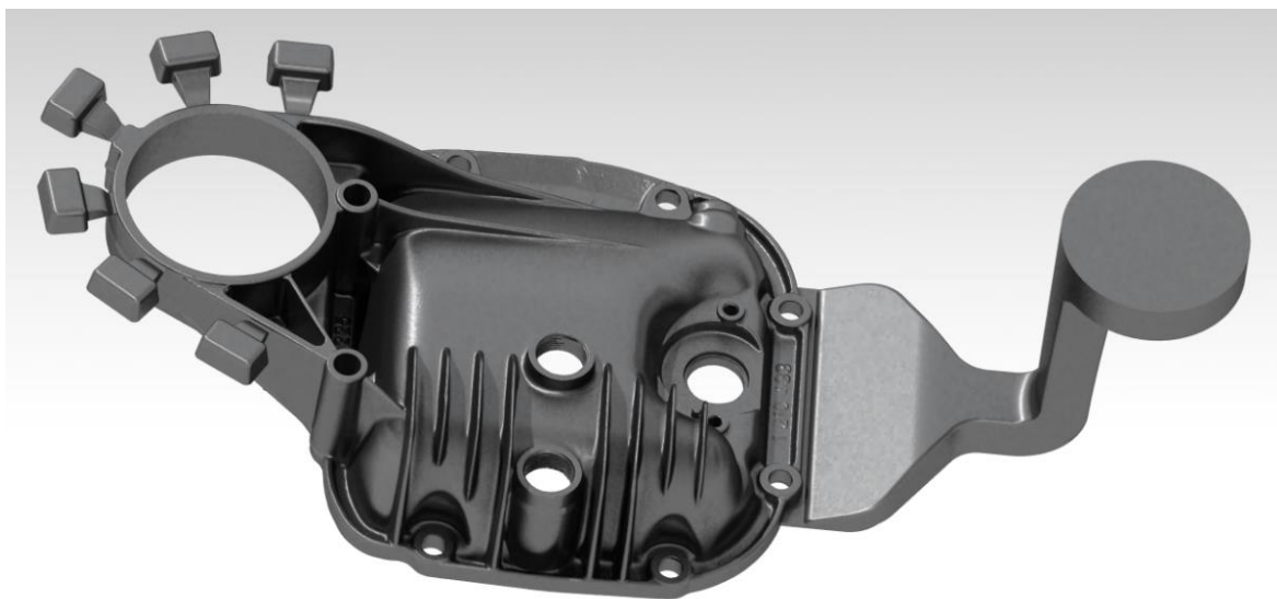
Slika 48. Renderirani CAD model sa sustavom za ulijevanje
