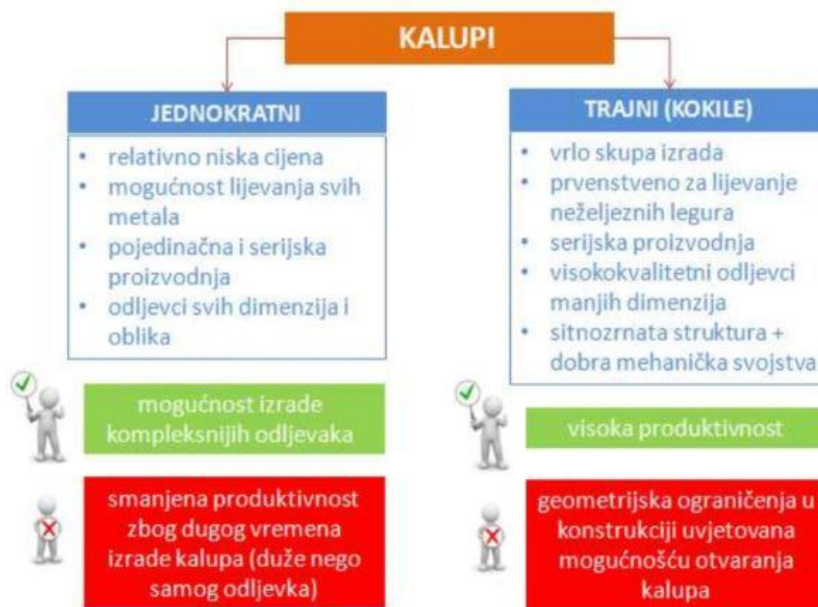
Slika 4. Osnovne značajke jednokratnih i trajnih kalupa [4]
