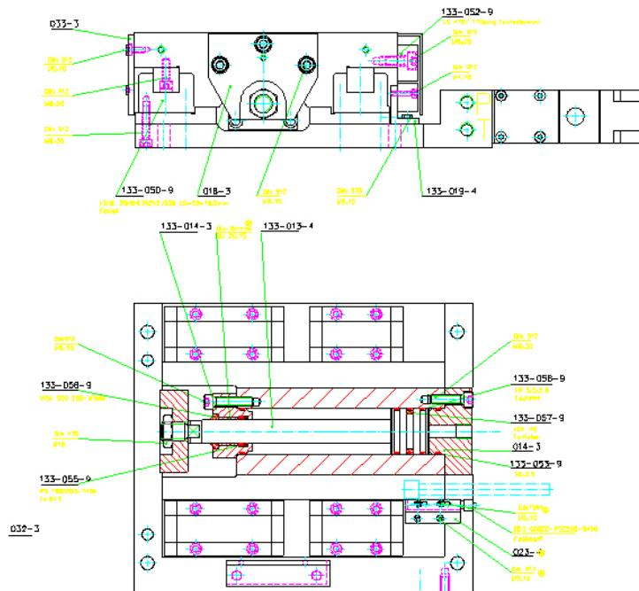
**Slika 18.** Primjer hidrauličkog posmičnog pogona
