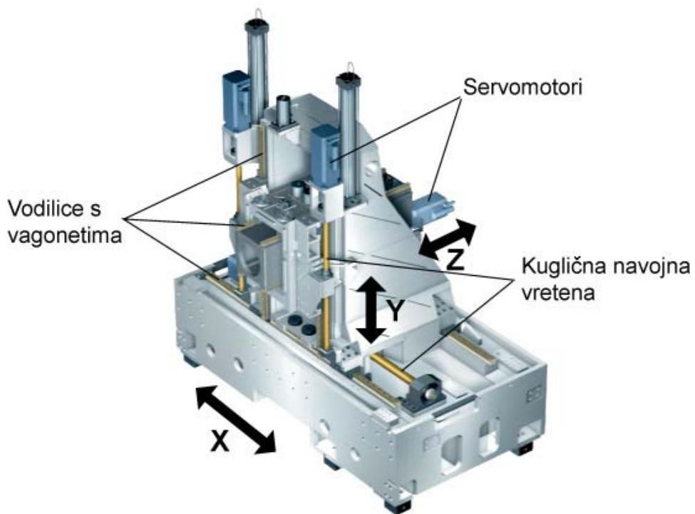
*Slika 4. Izgled obradne jedinke pogonjene motorima s kugličnim navojnim vretenima*
