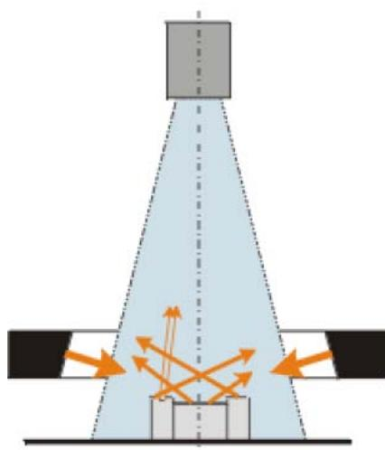
*Slika 49.* - Difuzno frontalno osvjetljenje tamnim poljem
