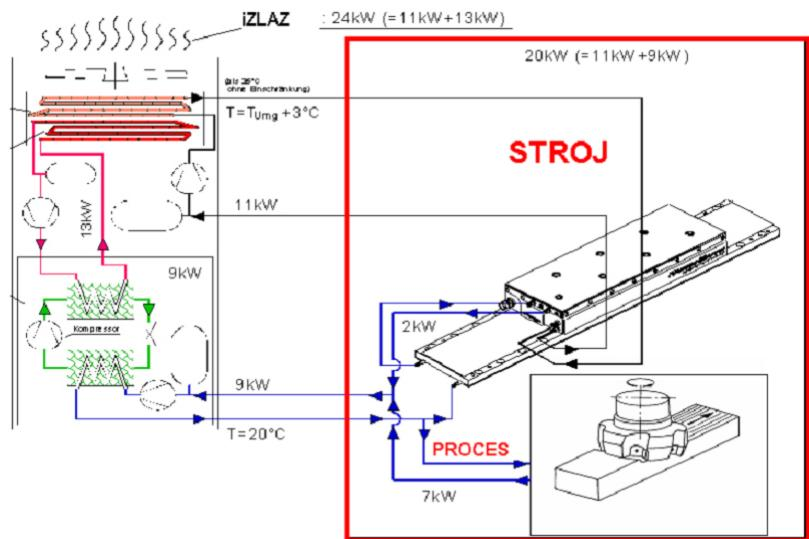
**Slika 15.** Primjer izvedbe hlađenja linijskog motora
