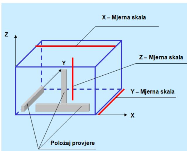
Položaj etalona za provjeru točnosti mjerenja duljina u prostoru TMU-a
