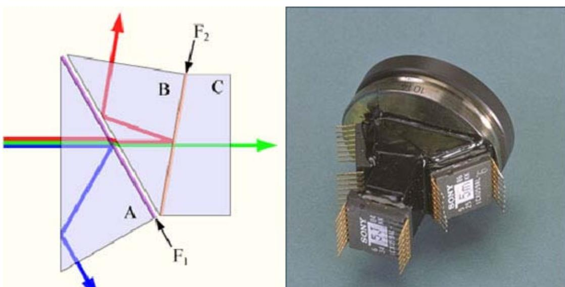
**Slika 28 – Izvedba osjetilnog senzora u boji**
