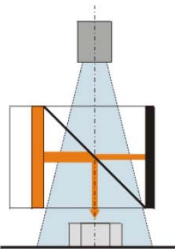
**Slika 55 - Frontalno osvjetljenje duž osi kamere**
