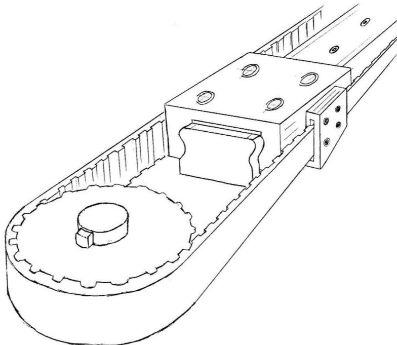
*Slika 6. Primjer remenskog prijenosa u kombinaciji sa vodilicom i fiksiranim klizačem za linearni pomak*
