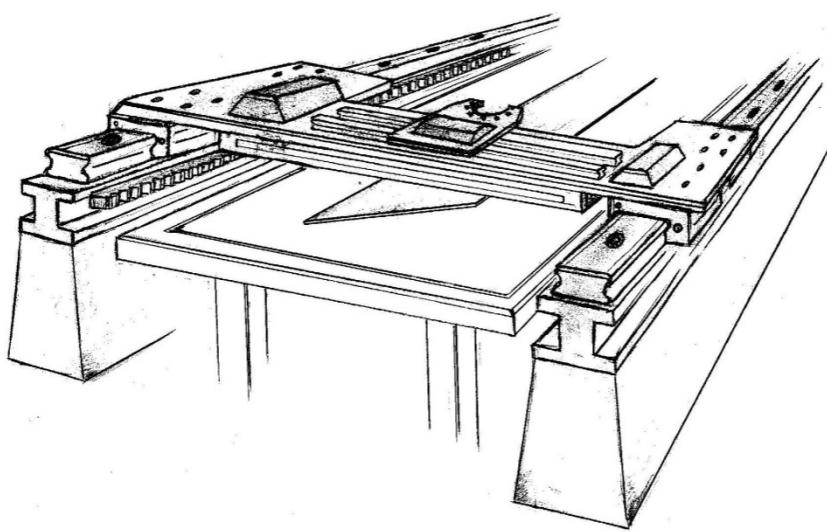
Slika 5. Magnetni stol za pričvršćivanje trafo limova
