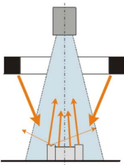
**Slika 48.** - Difuzno frontalno osvjetljenje svijetlim poljem
