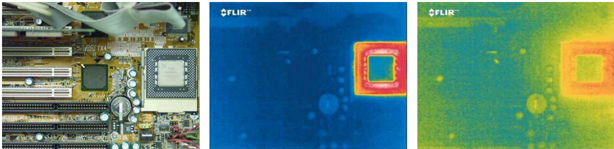
Slika 29. tiskana pločica snimana infracrvenom kamerom
