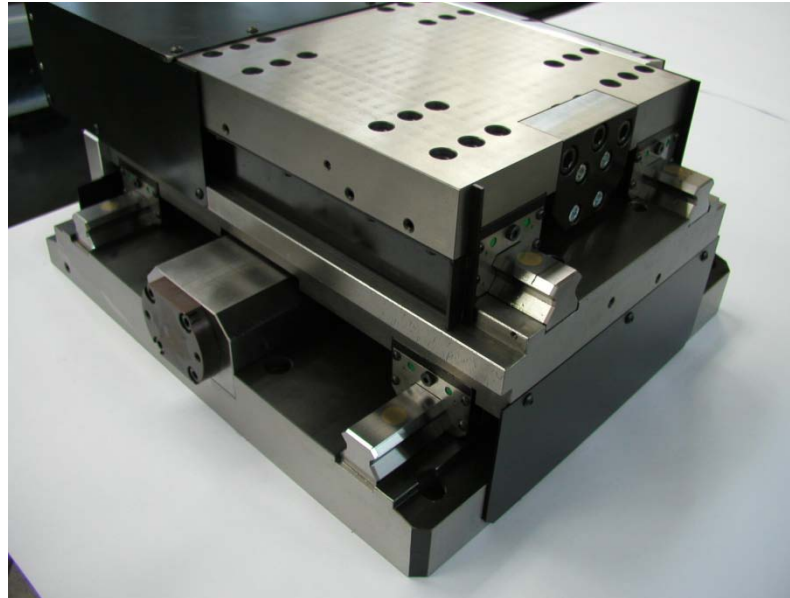
Slika 17. Primjer hidrauličkog posmičnog pogona
