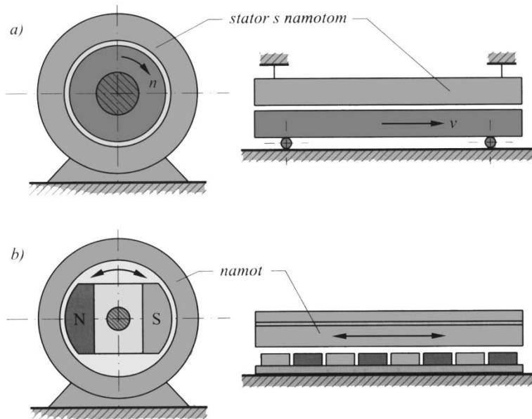
**Slika 12.** Prikaz nastanka linearnog motora iz rotacijskog
