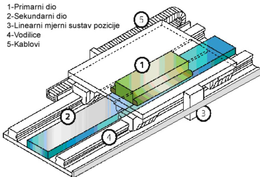
**Slika 7.** Posmični pogon s linearnim motorom
