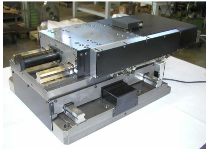
**Slika 10.** Primjeri primjene pogona s kugličnim navojnim vreštenom
