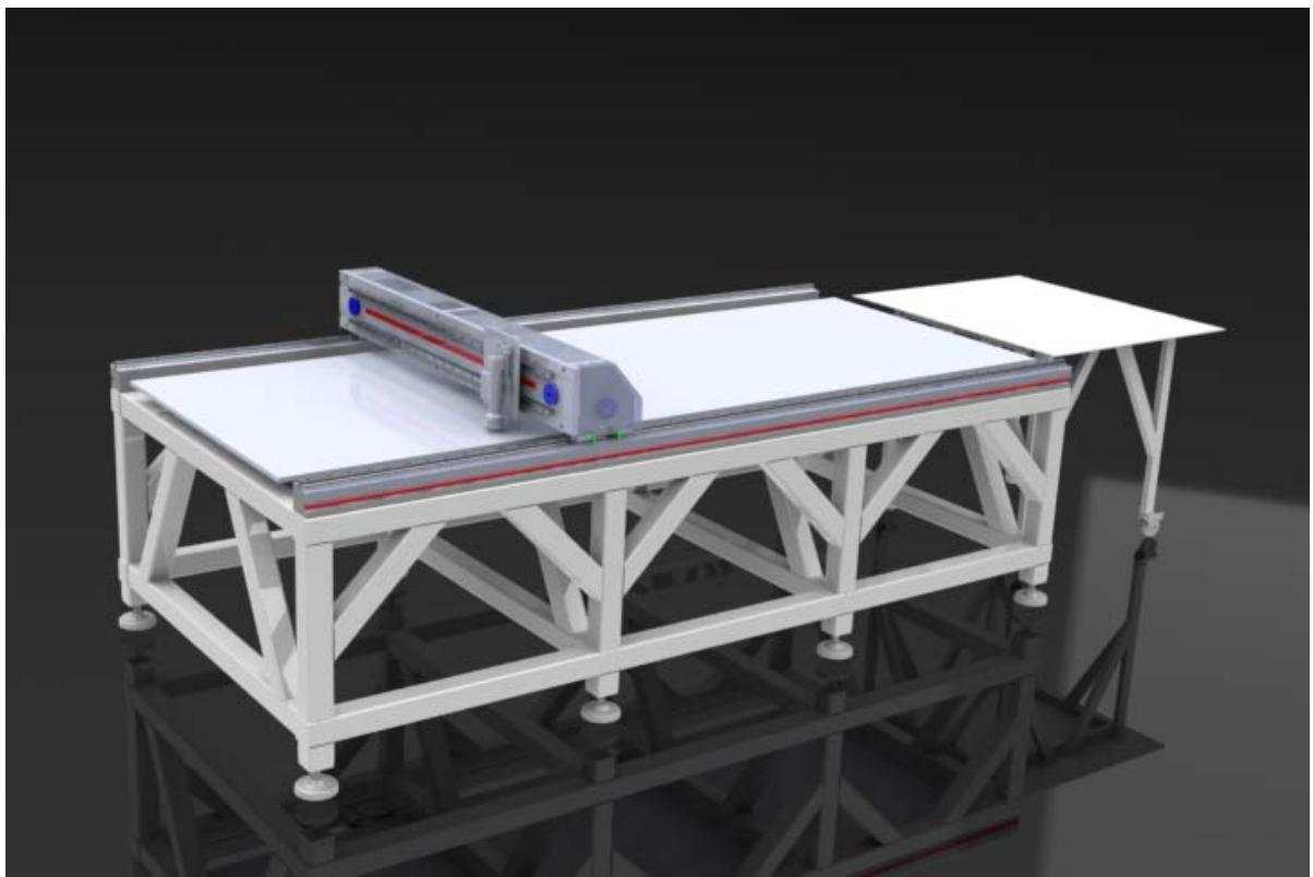
slika 13. kraća verzija postolja mjernog stroja uz dodatak za mjerjenja duljih limova
