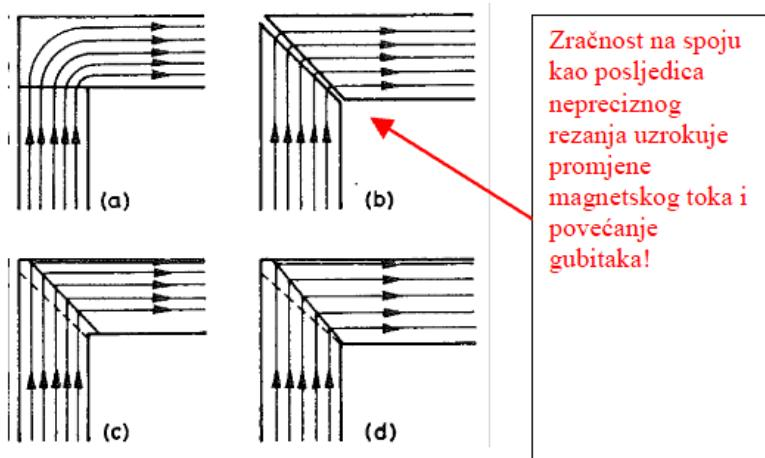
Slika 2. Nepovoljna zračnost spoja uslijed odstupanja dimenzija od zadanih
