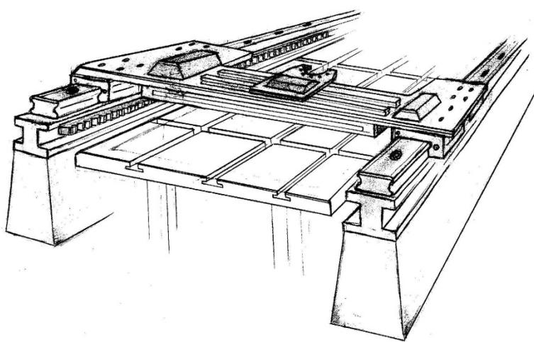
Slika 4. Stol s mehaničkim pričvršćivanje trafo limova
