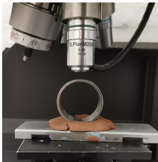
Slika 71. Ispitivanje tvrdoće površine
