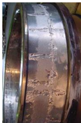
Slika 10. Oštećenja nastala tijekom rada ležaja [8]
