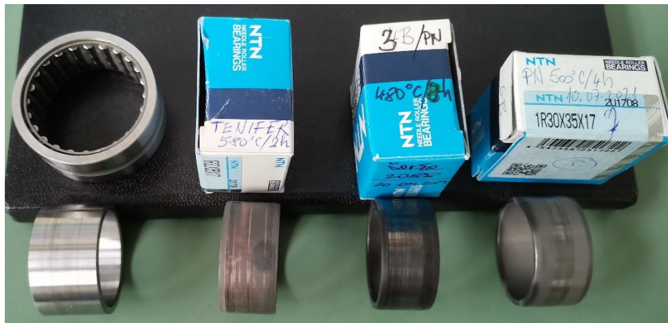
Slika 74. Prstenovi nakon provedbe ispitivanja bez podmazivanja
