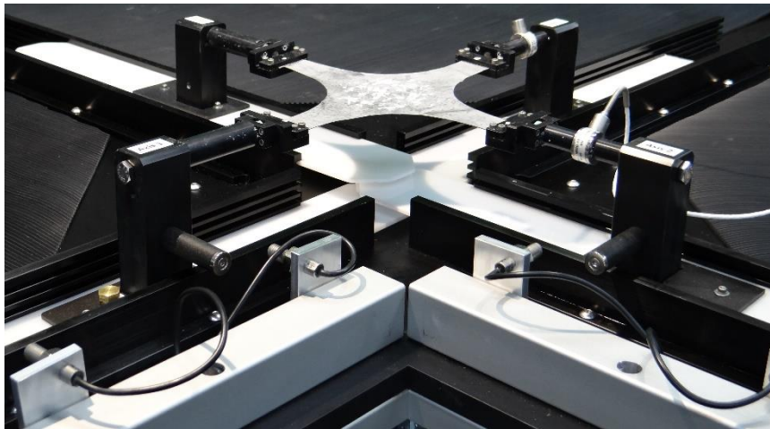
Slika 10. ADMET dvoosna kidalica – čeljusti [3]
