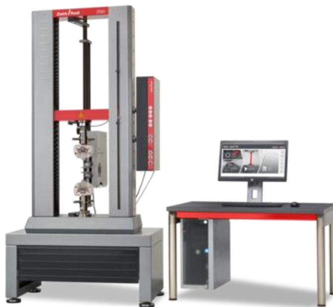
Slika 2. Jednoosna vlačna kidalica [2]
