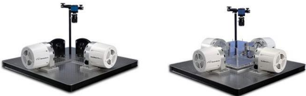
Slika 11. ElectroForce kidalica s dva motora (lijevo) i četiri motora (desno) [4]
