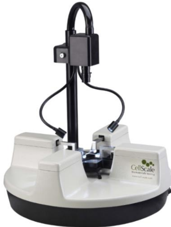
Slika 12. CellScale dvoosna kidalica [5]
