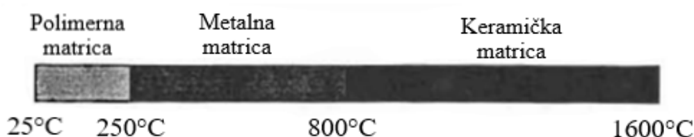
Slika 6. Usporedba temperatura primjene glavnih tipova materijala matrice [16]
