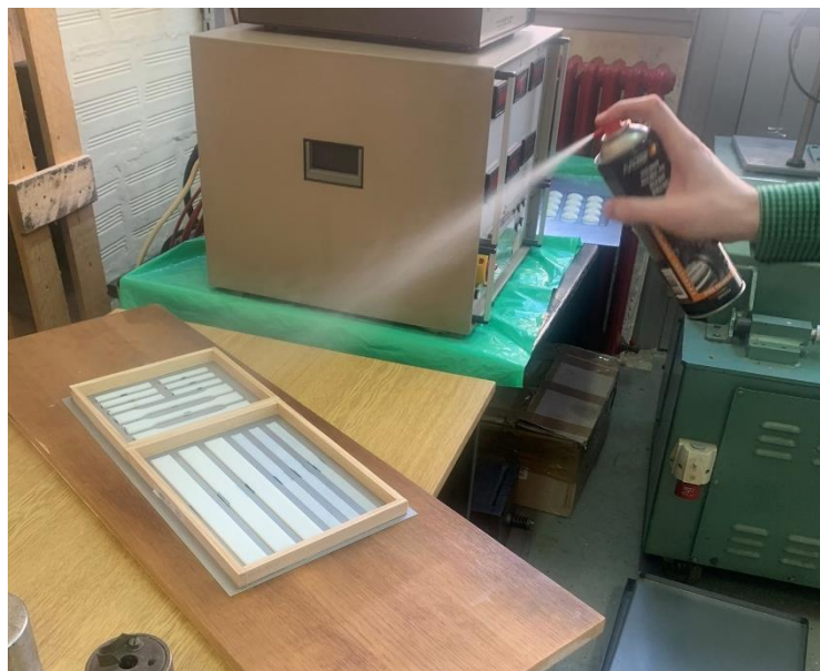
Slika 31. Prskanje kalupa PTFE sprejom
