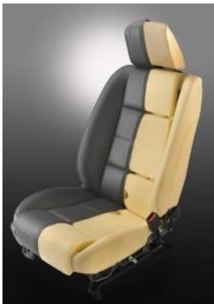
Slika 17. Sjedalo od polimera ojačanog kokosovim vlaknima [23]
