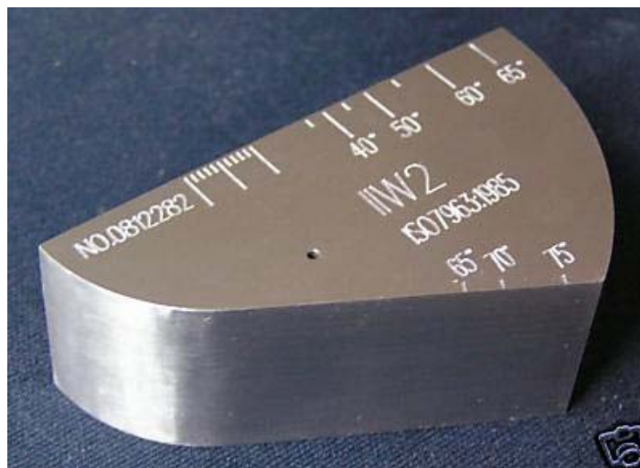
Slika 10. Referenti etalon V2
