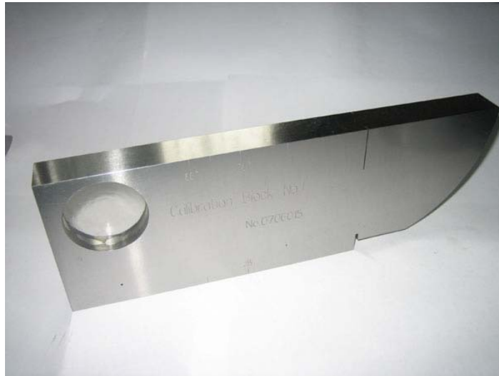
Slika 9. Referentni etalon V1
