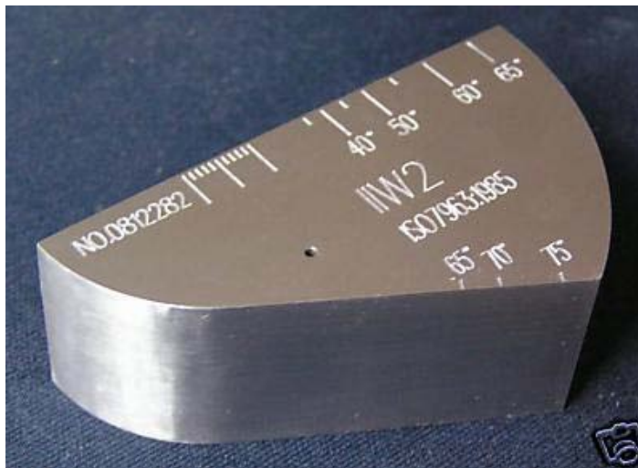
Slika 10. Referentni etalon V2
