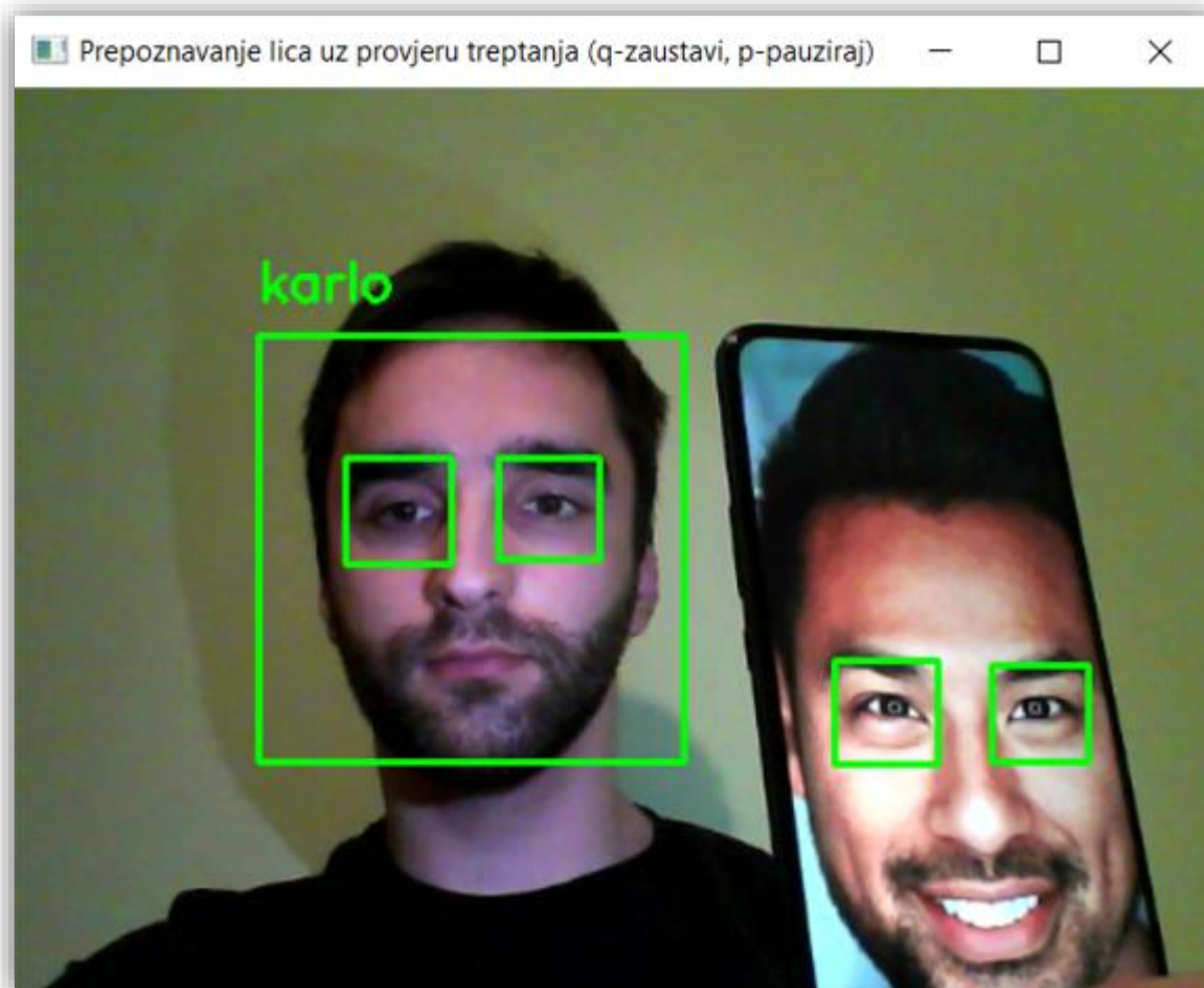
Slika 4.6. Prikaz rezultata dobivenog za pokušaj lažiranja pohadanja korištenjem fotografije ovlaštenog korisnika na mobitelu uz istovremeno prisustvu druge stvarne ovlaštene osobe
