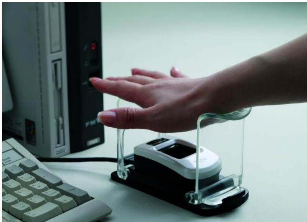
Slika 2.4. Prikaz upotrebe sustava za prepoznavanje rasporeda vena na dlanu [9]
