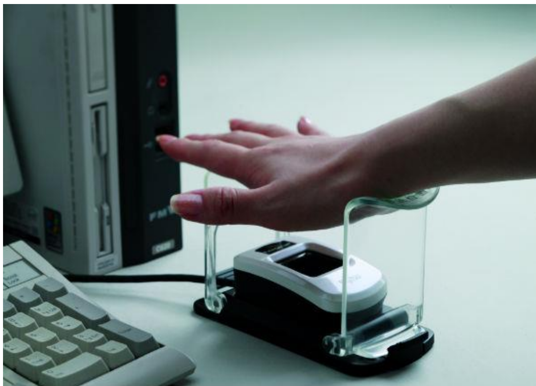
Slika 2.4. Prikaz upotrebe sustava za prepoznavanje rasporeda vena na dlanu [9]
