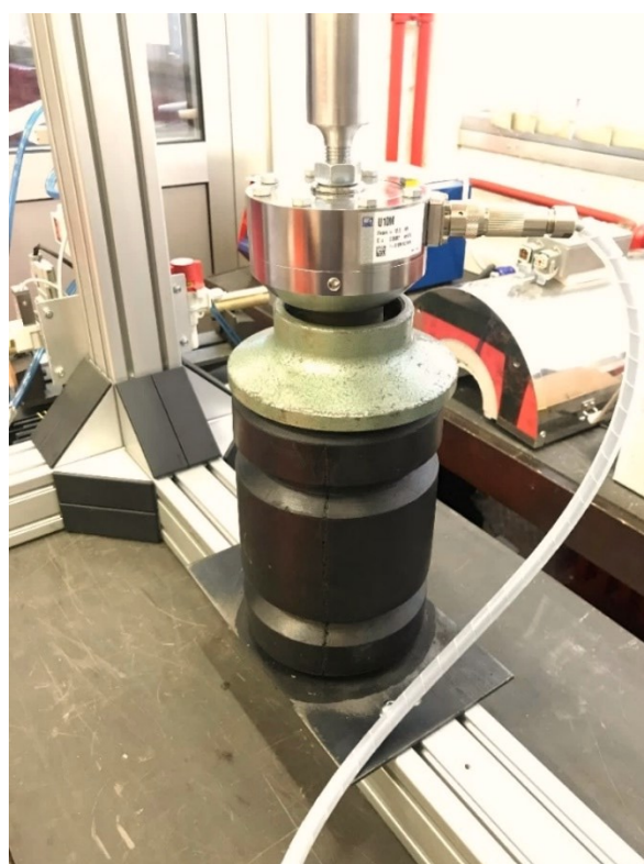
Slika 43. Eksperimentalni pristup estimiranju parametara s gumenim odstožnikom
