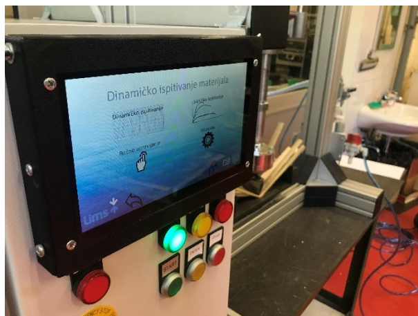
Slika 9. HMI sučelje eksperimentalnog postava
