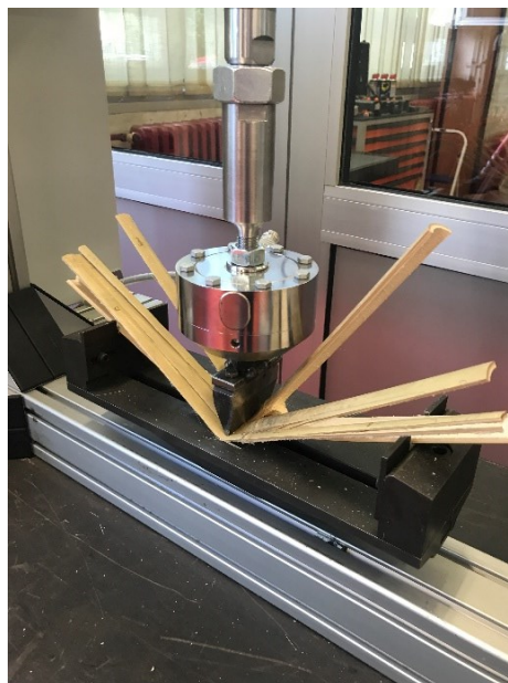
Slika 11. Uzorak nakon ispitivanja savojne čvrstoće
