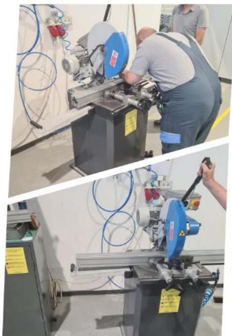
Slika 19. Mjerenje i rezanje sirovca
