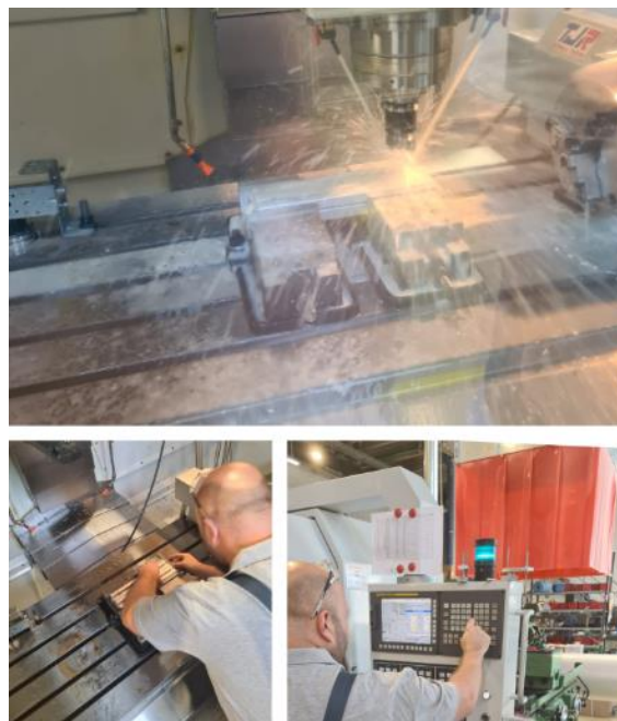
Slika 21. Stavljanje radnog komada u CNC stroj, pokretanje i nadgledanje
