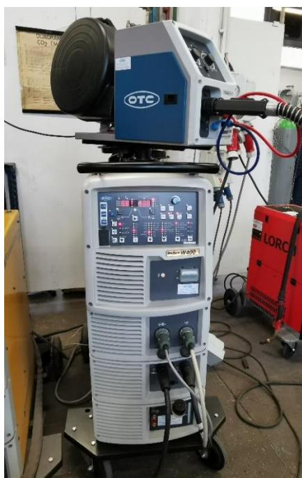
Slika 20 OTC Welbee W400 dual-inverterski izvor struje
