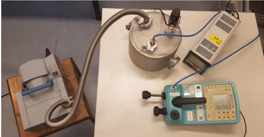
Slika 30. Spoj membranske pumpe na vakuum komoru
