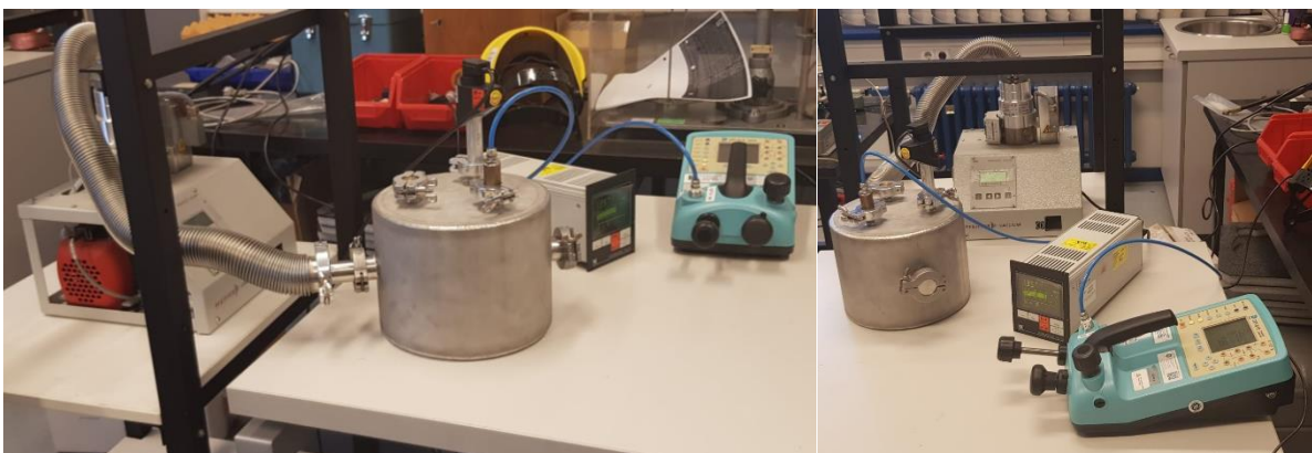
Slika 31. Spoj turbomolekularne pumpe na vakuum komoru
