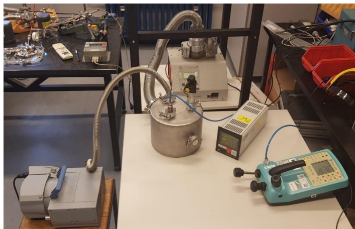
Slika 32. Spoj membranske i turbomolekularne pumpe na vakuum komoru
