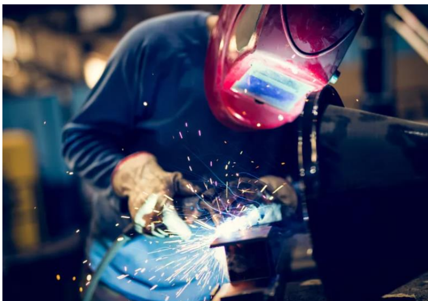
Slika 13. MIG postupak zavarivanja [18]
