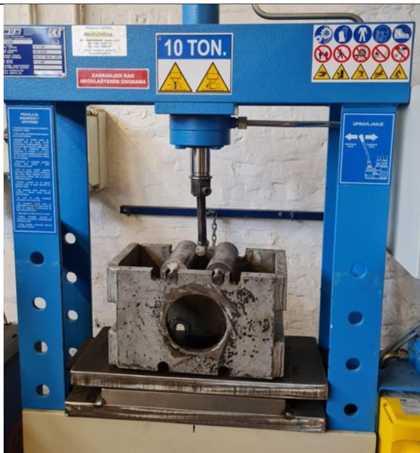
Slika 51. Stroj za ispitivanje savijanjem
