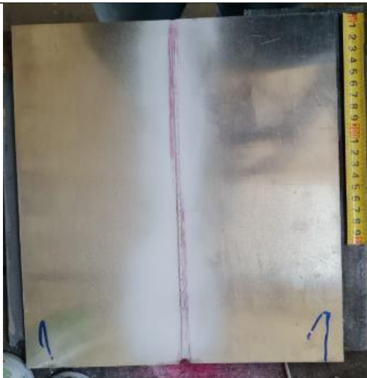
Slika 39. Rezultati ispitivanja penetrantima na korijenu DC zavora
