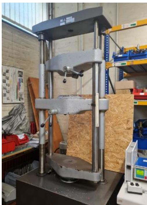
Slika 41. Univerzalna kidalica WPM Njemačka, model EU 40 MOD
