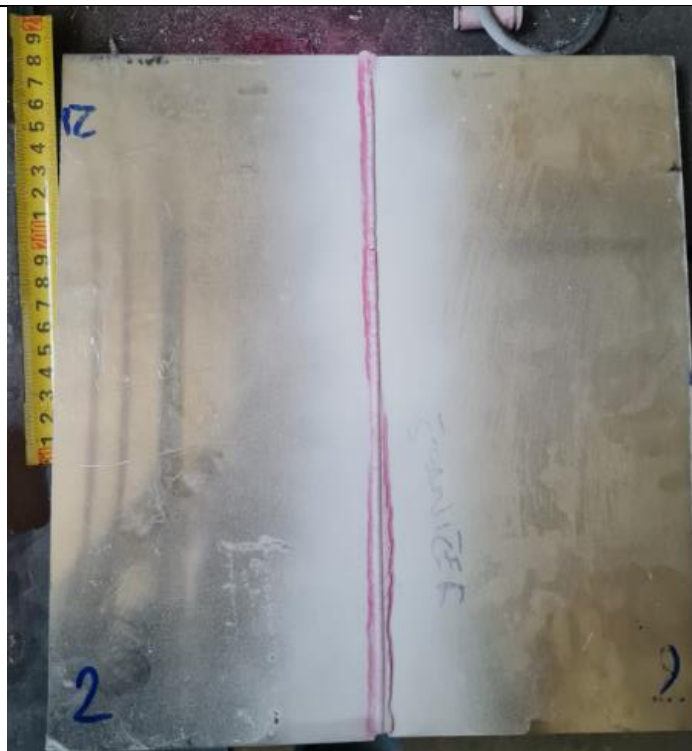
Slika 37. Rezultati ispitivanja penetrantima na korijenu AC zavara
