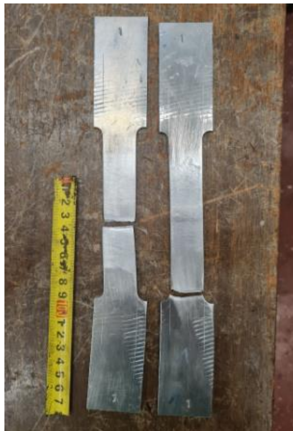
Slika 44. Uzorak 1a i 1b DC zavarenog spoja nakon ispitivanja na kidalici
