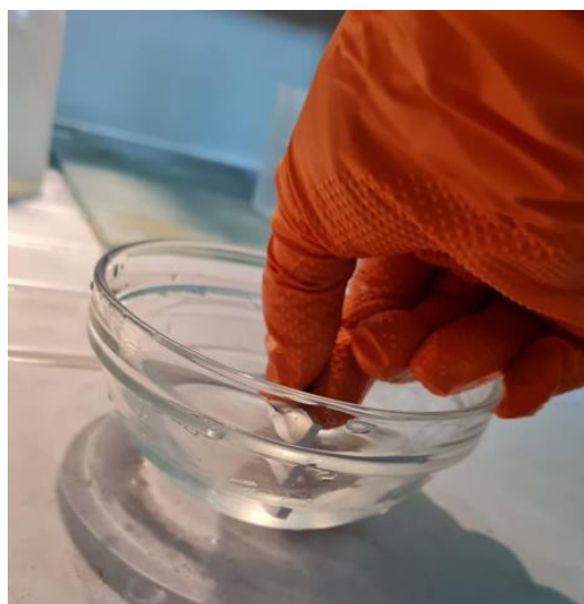
Slika 55. Nagrivanje uzorka u Keller otopini
