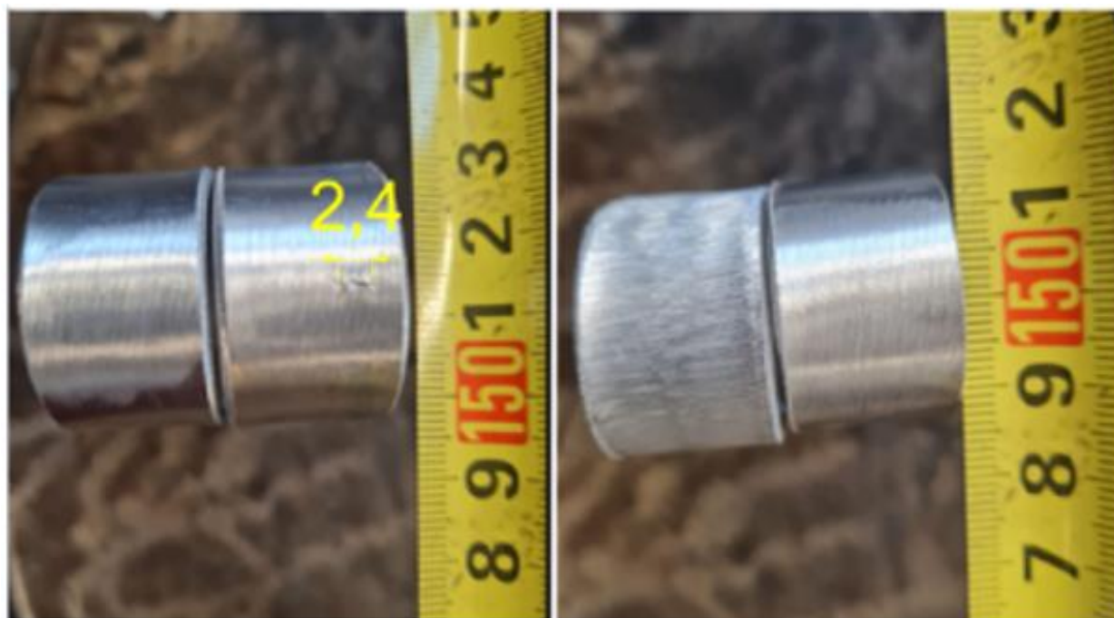
Slika 52. Korijeni i lica DC zavora ispitanih savijanjem
