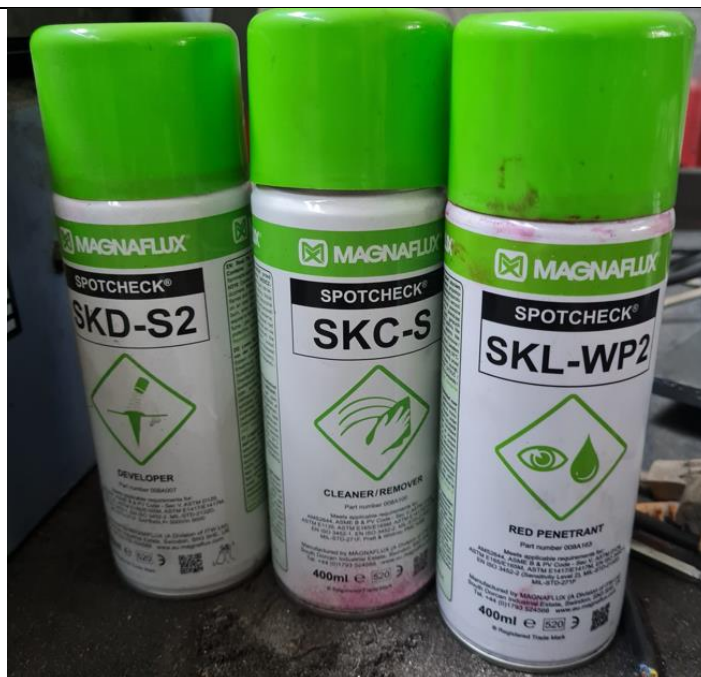
Slika 35. Sredstva koja se koriste kod ispitivanja penetrantima
