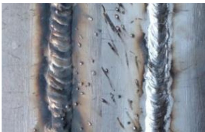
Slika 17. Pogrešna i ispravna tehnika zavarivanja aluminija [15]
