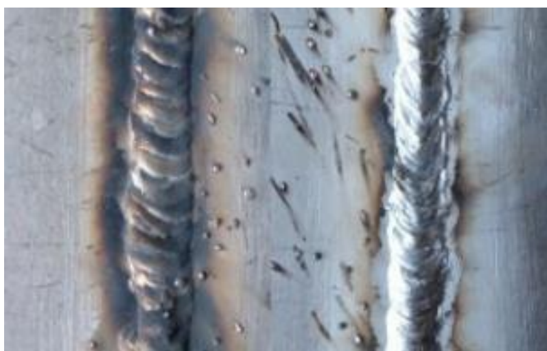
Slika 17. Pogrešna i ispravna tehnika zavarivanja aluminijski [15]
