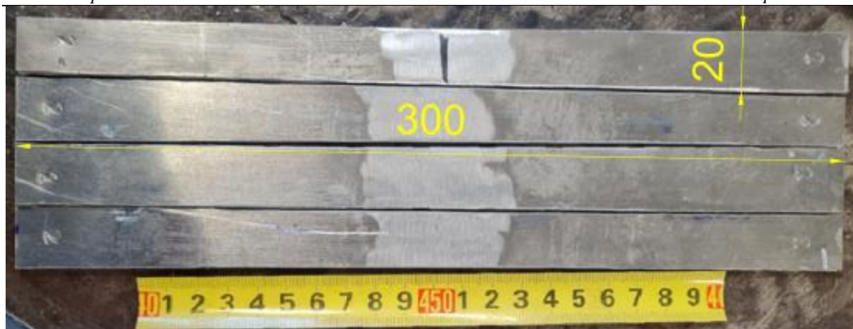
Slika 50. Epruvete uzete od AC uzoraka spremne za ispitivanje savijanjem
