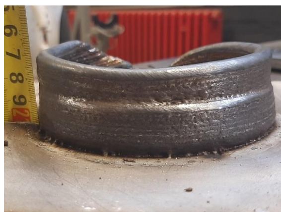
Slika 28. Uzorci nakon čišćenja i odmaščivanja
