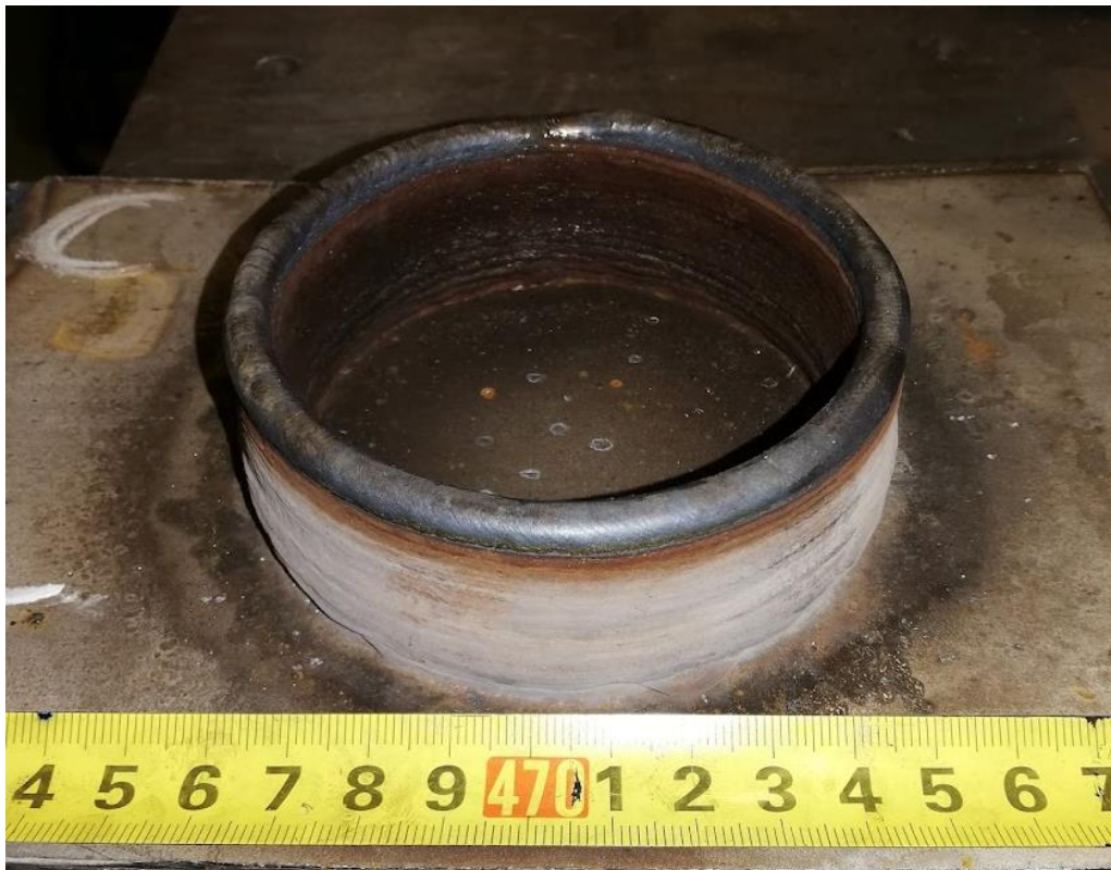
Slika 26. Uzorak C nakon zavarivanja
