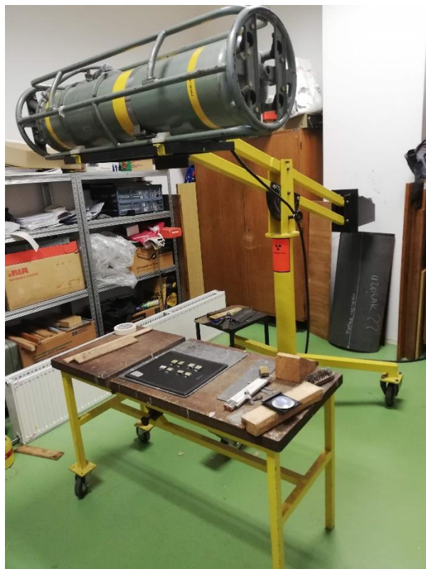
Slika 50. Oprema za radiografsko ispitivanje
