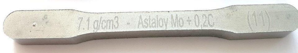
Slika 24 Epruveta materijala Astaloy Mo+0,2C gustoće 7,1 \text{ g/cm}^3
