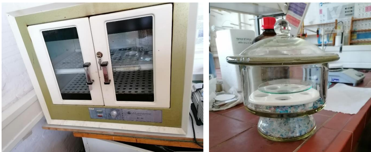
Slika 25 Prikaz sušionika (lijevo) i eksikatora (desno)
