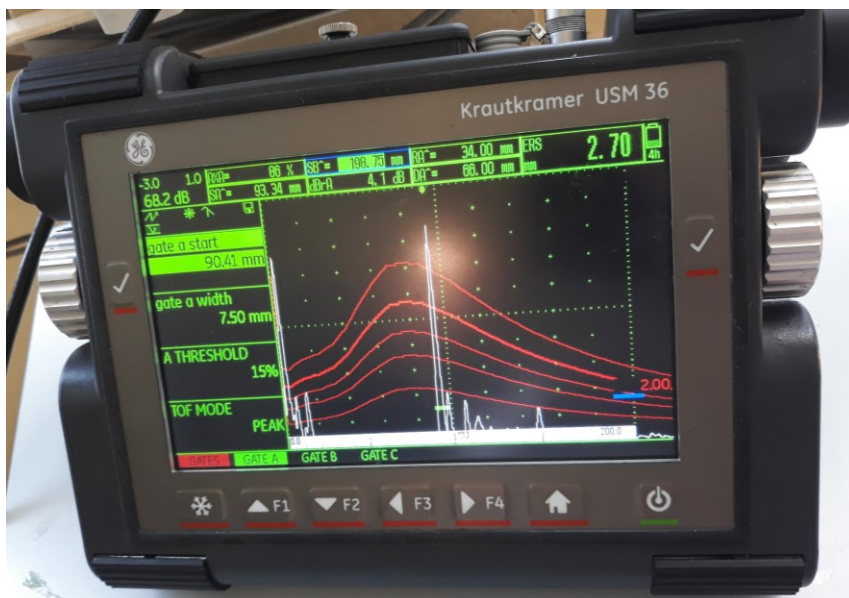
Slika 74. Ekran uređaja pri detektiranju SDH 1 sondom WB 45-2
