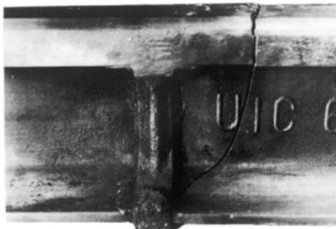
Slika 8. Primjer greške označene kodom 421 [13]
