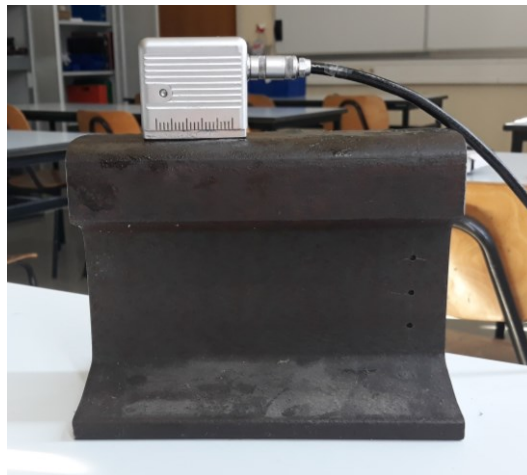
Slika 59. Detektiranje reflektora FBH 1 sondom WB 45-2
