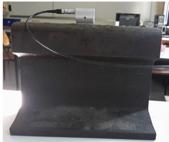
Slika 33. Detektiranje reflektora SDH 2 sondom MWB 45-2
