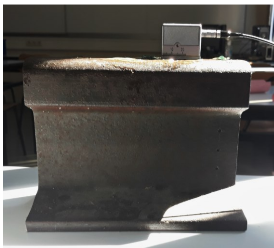
Slika 43. Detektiranje reflektora FBH 3 sondom SWB 45-2
