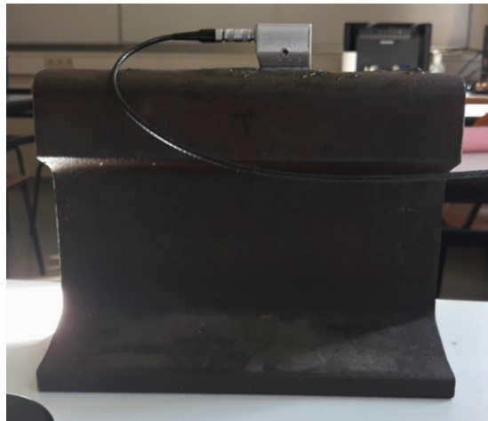
Slika 32. Detektiranje reflektora SDH 1 sondom MWB 45-2
