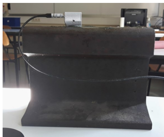
Slika 34. Detektiranje reflektora SDH 3 sondom MWB 45-2
