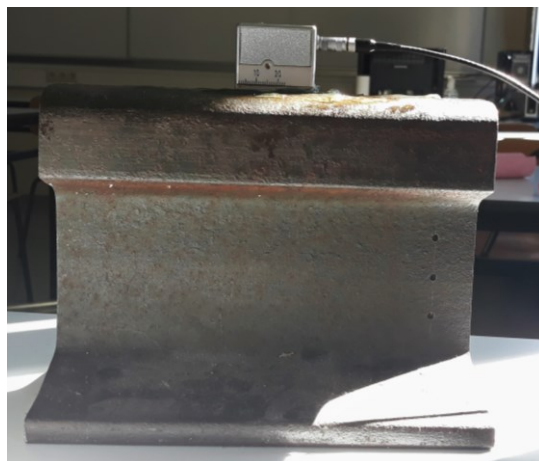
Slika 42. Detektiranje reflektora FBH 2 sondom SWB 45-2
