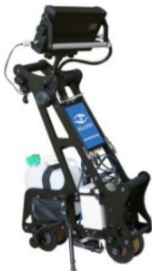
Slika 11. UDS2-77 proizvođača OKOndt GROUP [22]
