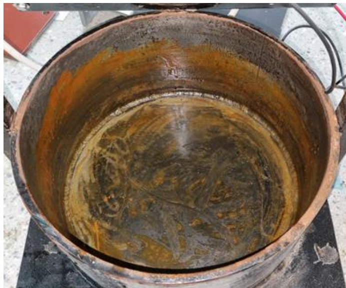
Slika 29. Spremnik nakon 45 dana ispitivanja
