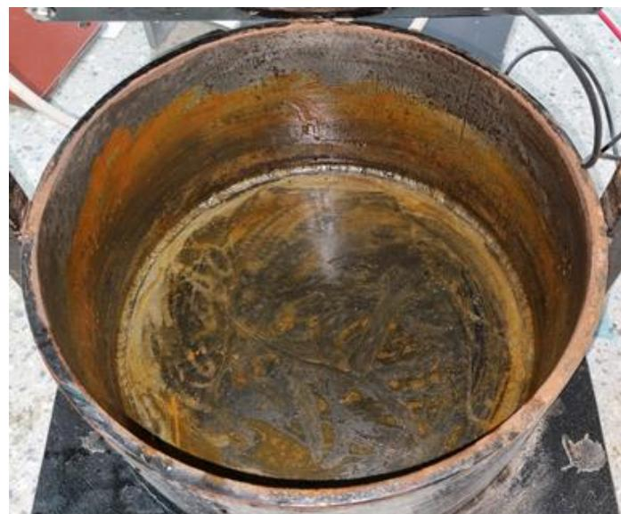
Slika 29. Spremnik nakon 45 dana ispitivanja
