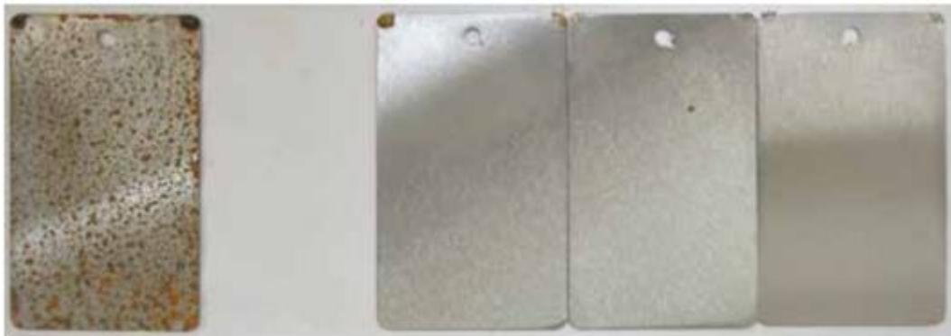
Slika 14. ASTM D1735 – rezultati ispitivanja s proizvodom A [23]
