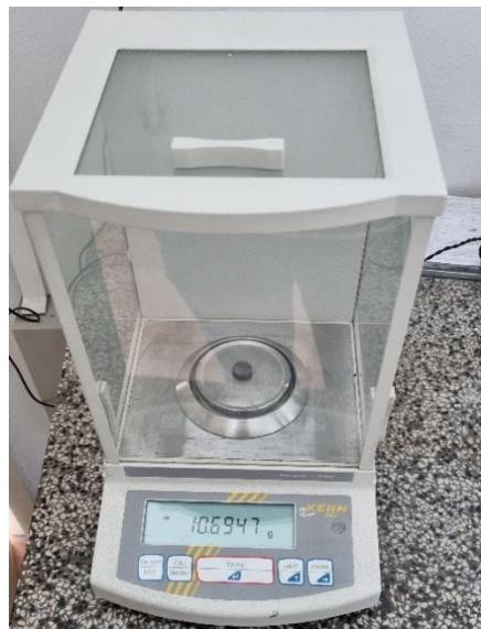
**Slika 30. Vaga za mjerjenje mase uzorka****Tablica 10. Rezultati vaganja uzorka prije i nakon ispitivanja**
