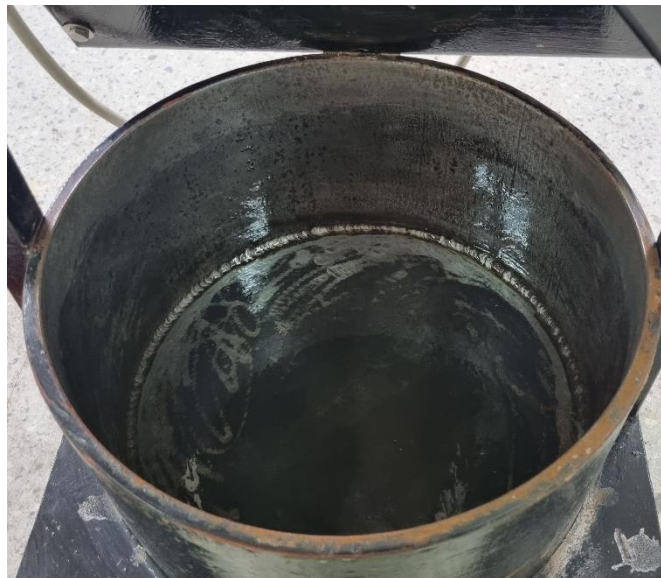
Slika 27. Model spremnika nakon nanesenog sloja M-645
