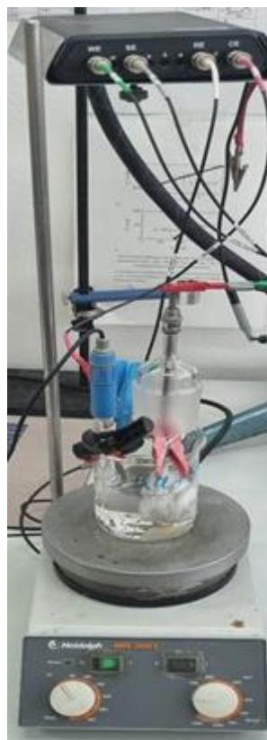
**Slika 16. Elektrokemijska ćelija s elektrodama**
