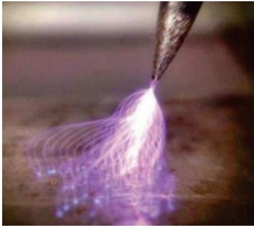
Slika 9. Uspostavljanje luka uz visokofrekventni generator [14]
