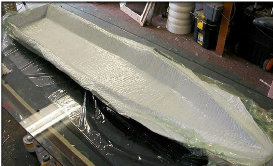
Slika 5.9. Podtlačno oblikovanje trupa radio-upravljanog zrakoplova [27]
