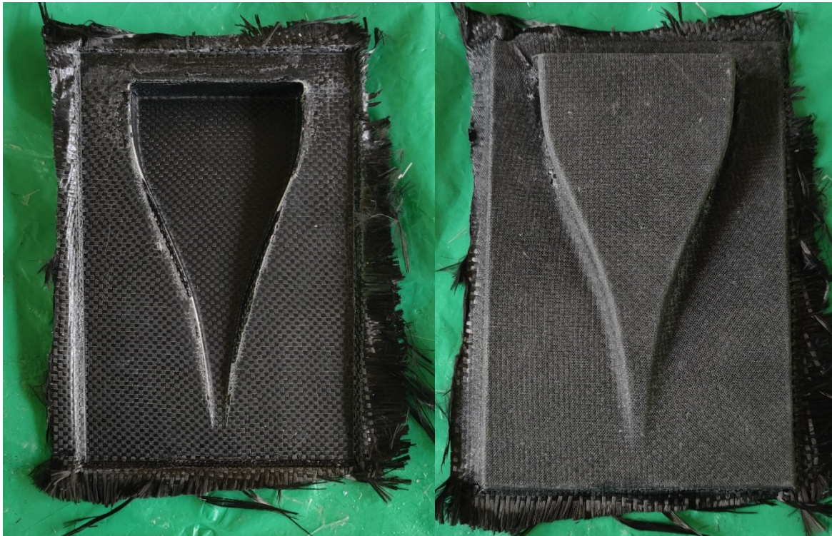
Slika 7.14. Kompozitna tvorevina izrađena polaganjem ugljičnih vlakana na pozitivni oblik kalupa, tj. na vanjsku stranu kalupa
