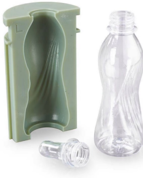
Slika 6.4. Kalup za injekcijsko puhanje izrađen postupkom Polyjet pomoću materijala digitalni ABS [32]
