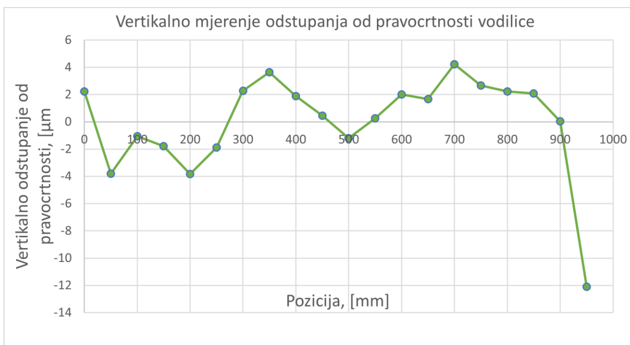
Slika 39. Graf idealnog stanja vodilice po vertikalnoj osi
