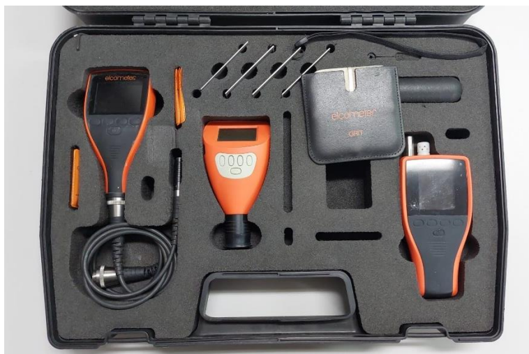
Slika 20. Uređaj za mjerenje debljine prevlake – Elcometer 456
