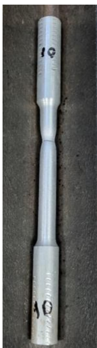
Slika 19. Epruveta 10 nakon ispitivanja
