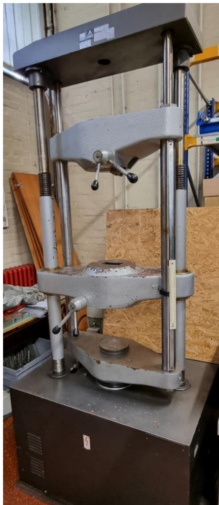
Slika 12. Kidalica VEB WPM / Eumod / 400 kN
