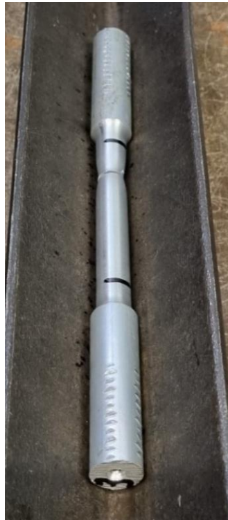
Slika 15. Epruveta 3 nakon ispitivanja
