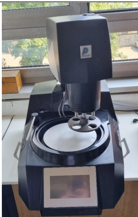
Slika 22. Uređaj za brušenje i poliranje Mecatech 250 – PRESI
