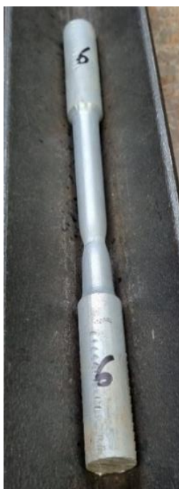
Slika 20. Epruveta 6 nakon ispitivanja
