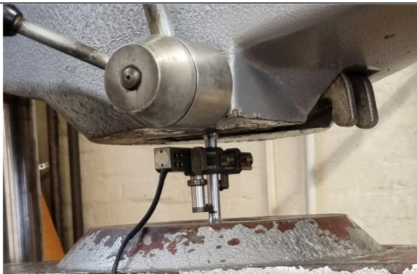
Slika 13. Elektronski ekstenziometar MFA2
