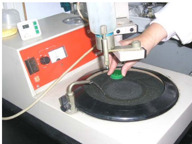
Slika 4.19 Uređaj za brušenje STRUERS DAP - V
