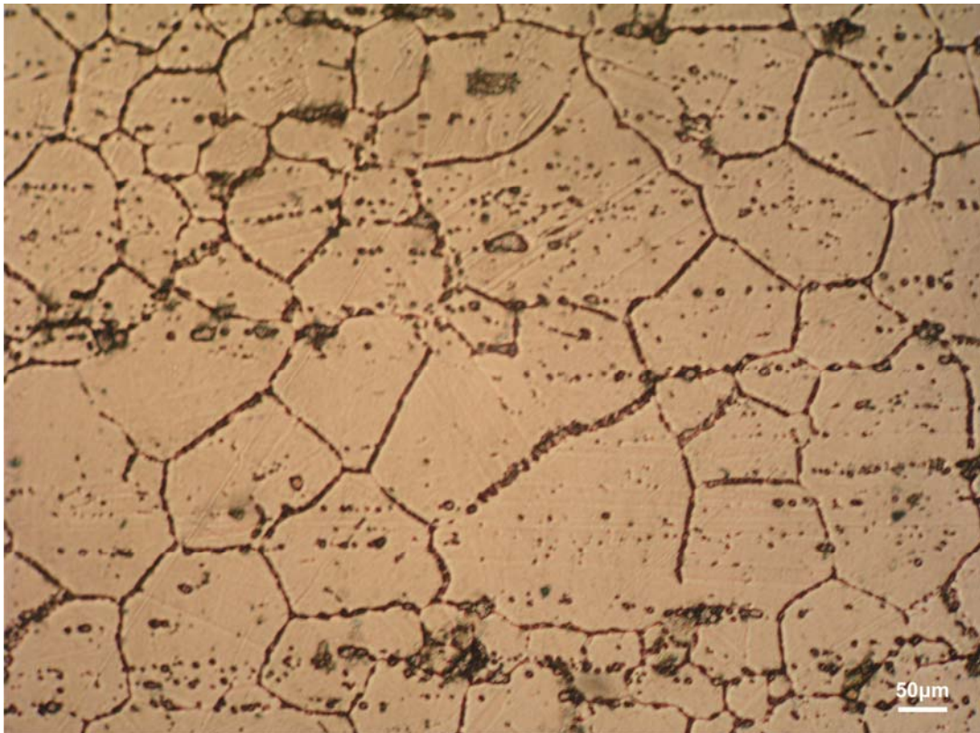
Slika 4.29 Mikrostruktura materijala u nagriženom stanju u sredini stjenke (veće povećanje)
