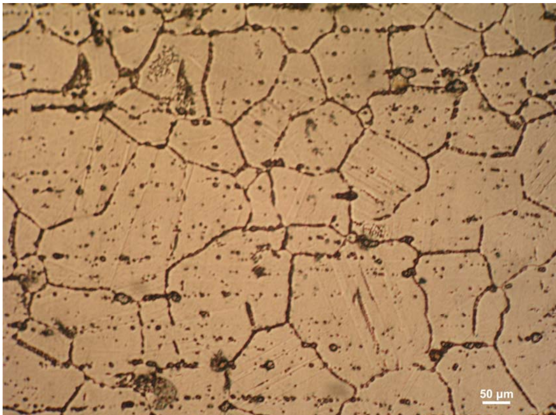
Slika 4.30 Mikrostruktura materijala u nagriženom stanju u sredini stjenke (drugo mjesto)
