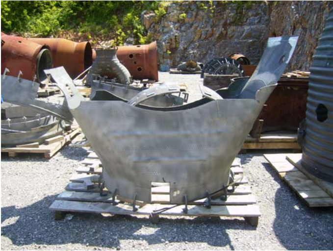
Slika 4.3 Dio kućišta vrućih plinova, s kojeg je izrezan uzorak za ispitivanje
