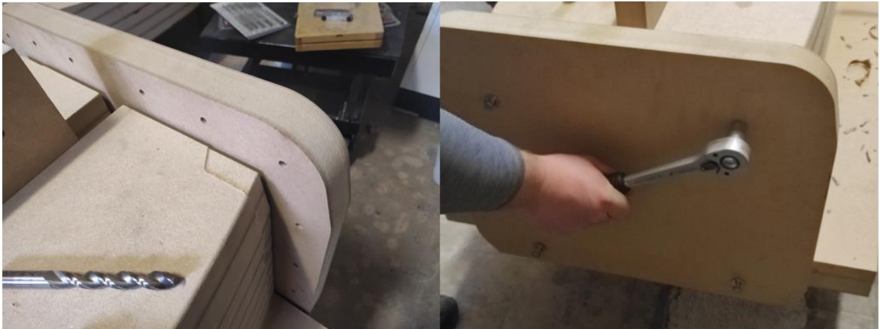
Slika 6.21. Montaža donjeg prednjeg poklopca: pozicioniranje poklopca zaticima (lijevo), stezanje vijaka (desno)
