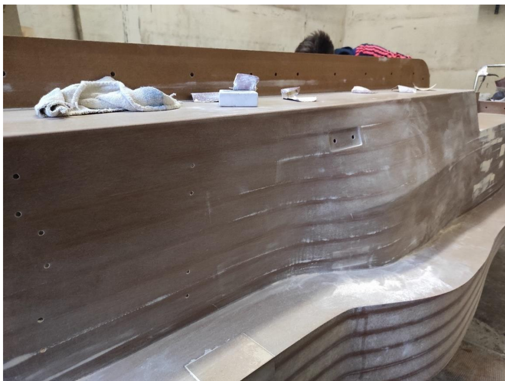
Slika 6.24. Kalup nakon nanošenja auto kita
