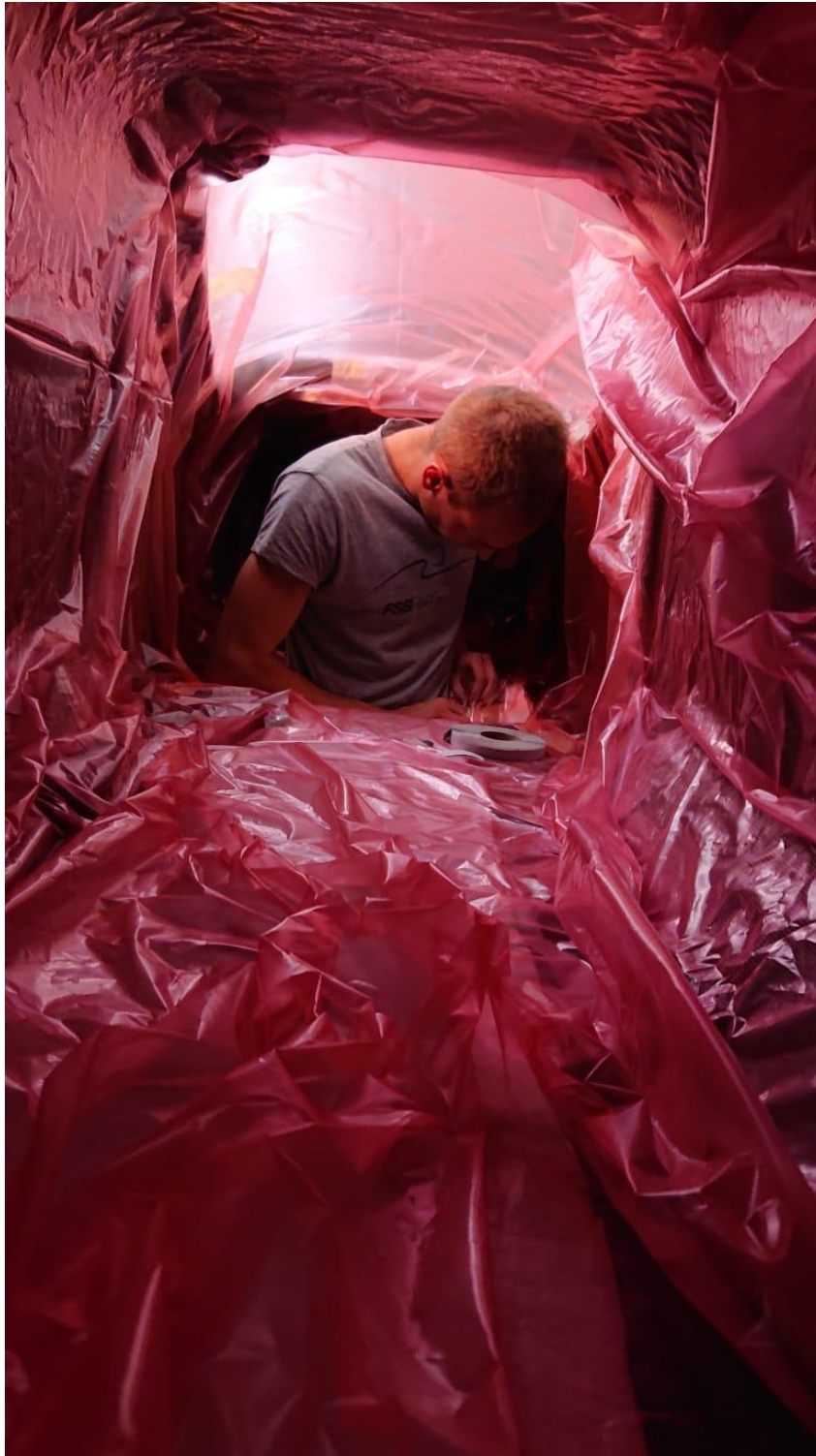
Slika 6.54. Podešavanje vreće unutar kalupa kod spajanja polovica prve šasije
