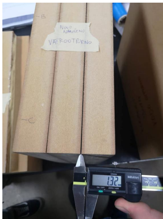
Slika 6.9. Ispitak s vatrootpornim ljepilom
