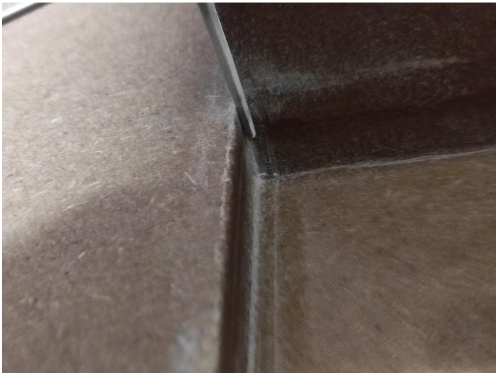
Slika 6.27. Uklanjanje srha i popravci polumjera na kalupu
