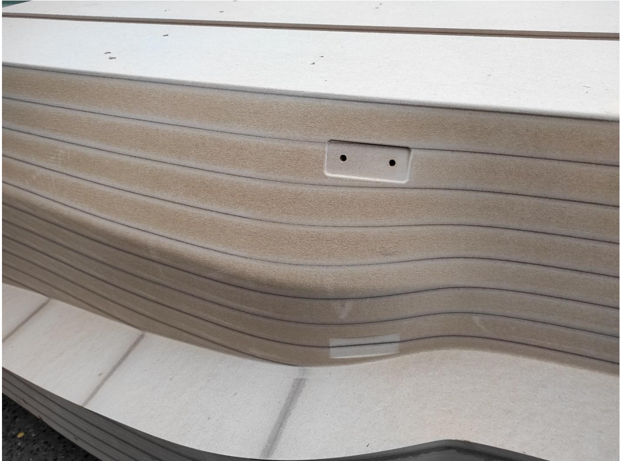
Slika 6.23. Površina donjeg kalupa nakon strojne obrade
