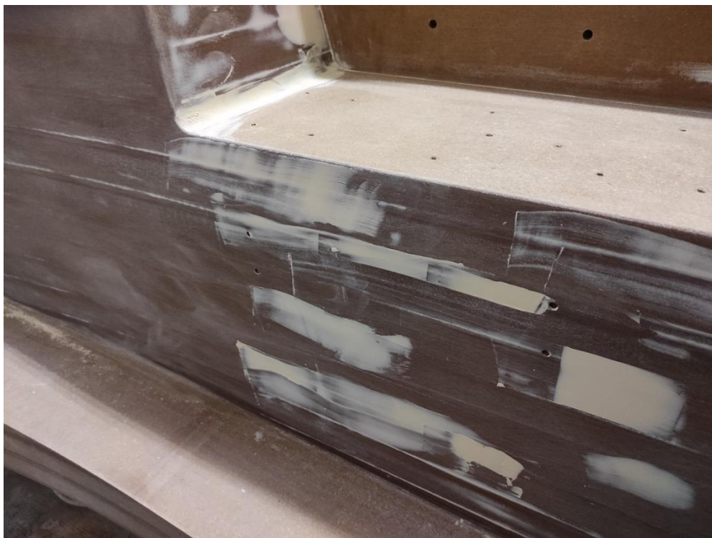
Slika 6.24. Kalup nakon nanošenja auto kita
