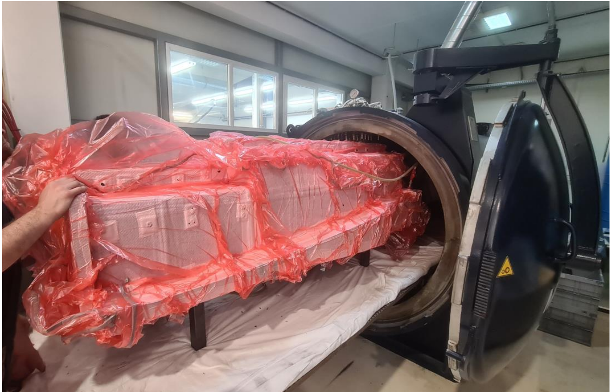
Slika 6.44. Stavljanje proizvoda u autoklav
