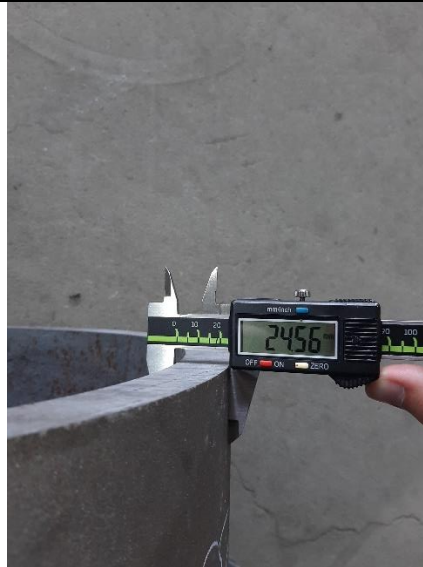
Slika 32. Debljina (24,56 mm) polovice epruvete
