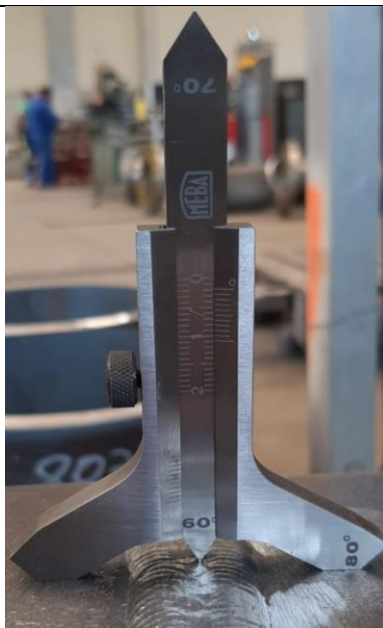
Slika 53. Nadvišenje zavarenog spoja epruvete U-1
