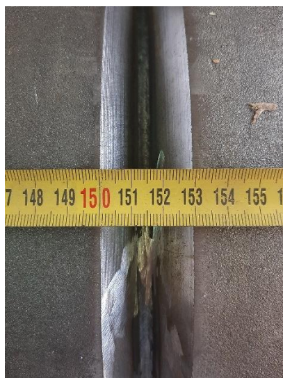
Slika 42. Lice korijena epruvete V-1
