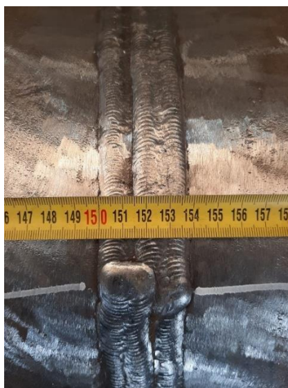
Slika 45. Lice zavarenoga spoja epruvete V-1
