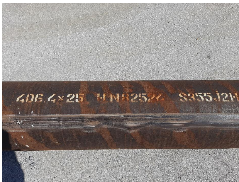
Slika 29. Bešavna cijev od materijala S355J2H
