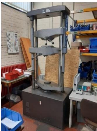
Slika 66. Univerzalna kidalica WPM EU 40 mod
