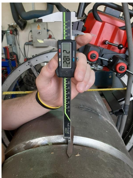
Slika 44. Dubina žlijeba nakon zavarivanja korijena epruvete V-1
