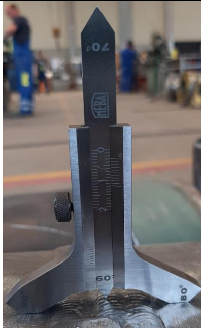
Slika 46. Nadvišenje zavarenoga spoja epruvete V-1
