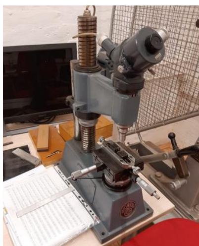
Slika 61. Tvrdomjer Reichter TM12
