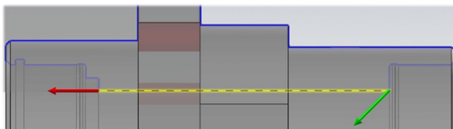
Slika 52. „Fino“ tokarenje provrta \phi 35 mm: definiranje konture
