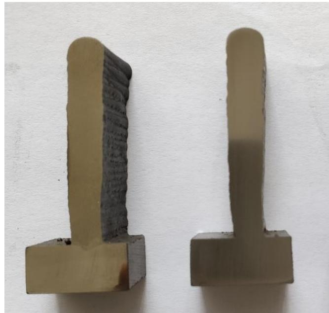
**Slika 25.** Uzorci izrezani iz navarenog zida (lijevo je žareni, desno nežaren uzorak)
