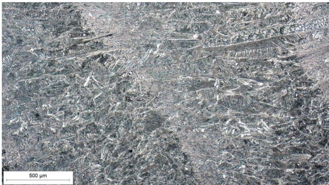
Slika 30. Mikrostruktura toplinski neobrađenog uzorka snimljena pri povećanju  $50\times$
