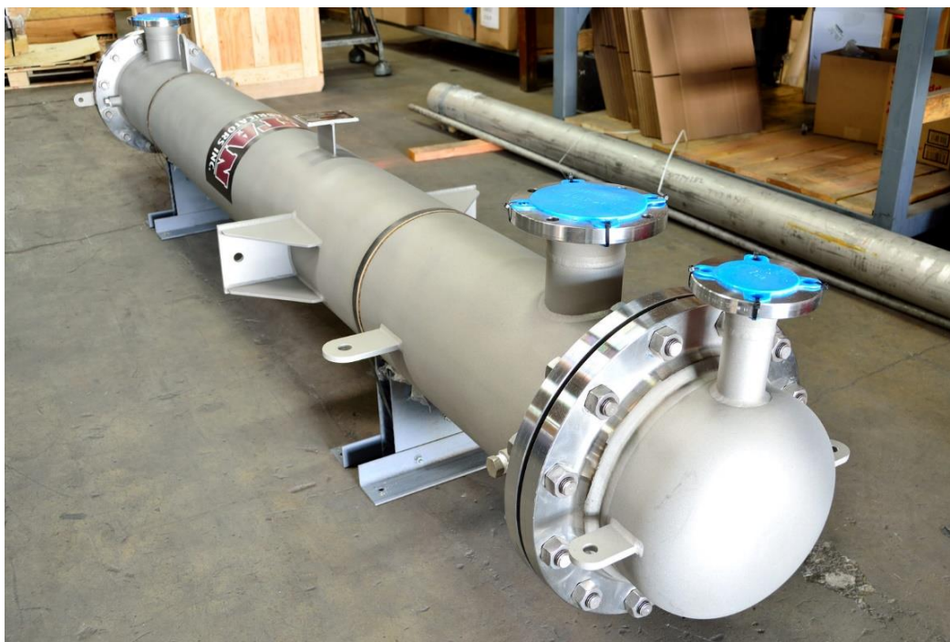
Slika 2. Izmjenjivač topline od čelika oznake X2CrNiMoN22-5-3 [5]
