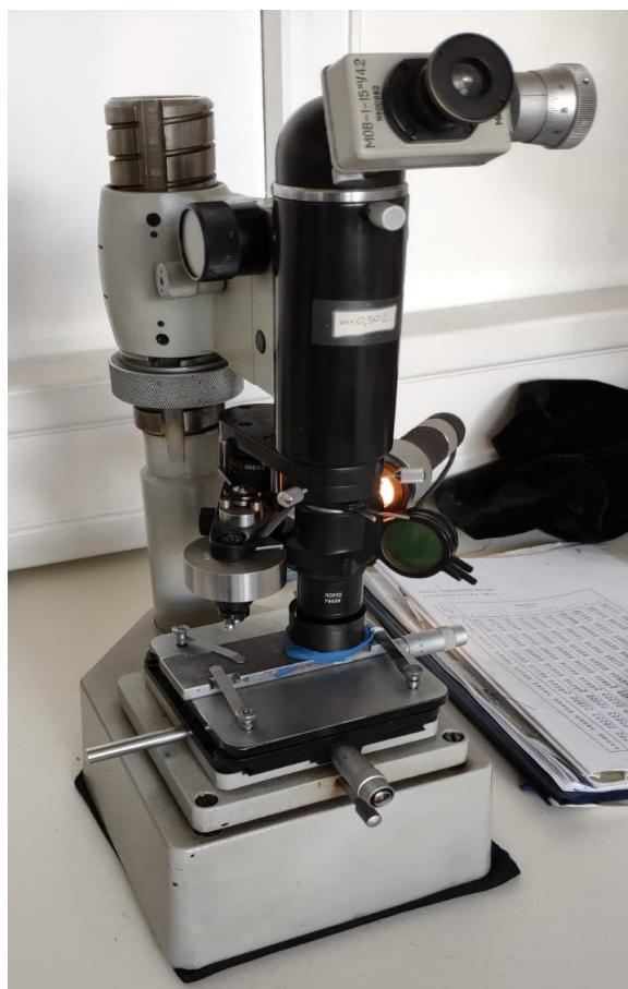
Slika 28. Mikrotvrdomjer PMT-3
