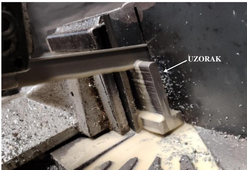
**Slika 24. Rezanje uzorka na tračnoj pili IMET GBS 185 Eco Autocut**
