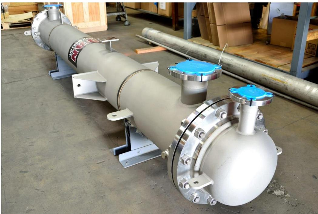
**Slika 2. Izmjenjivač topline od čelika oznake X2CrNiMoN22-5-3 [5]**
