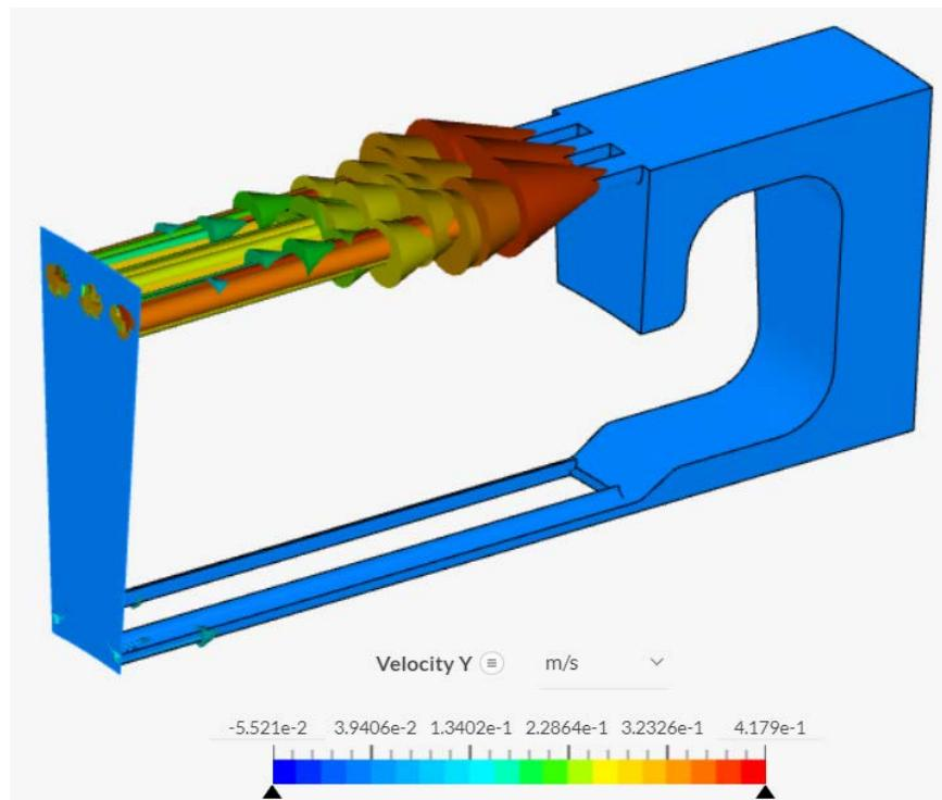
Slika 45. Brzina protoka u aksijalnom smjeru – V2, 15 L/min
