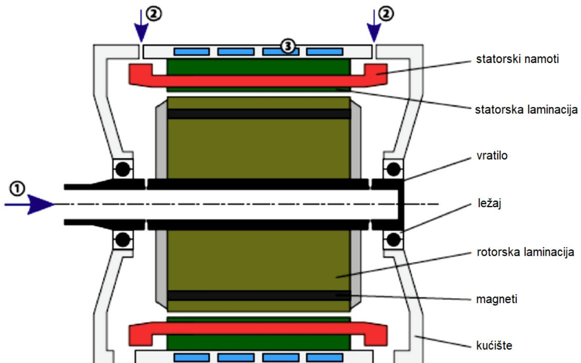
**Slika 18. Presjek motora hlađen uljnim mlazom [14]**
