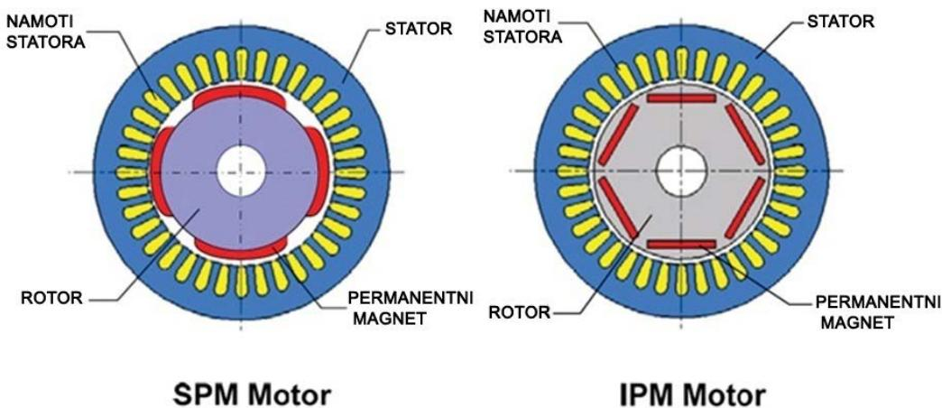
**Slika 3. Usporedba topologija SPMSM-a i IPMSM-a [4]**
