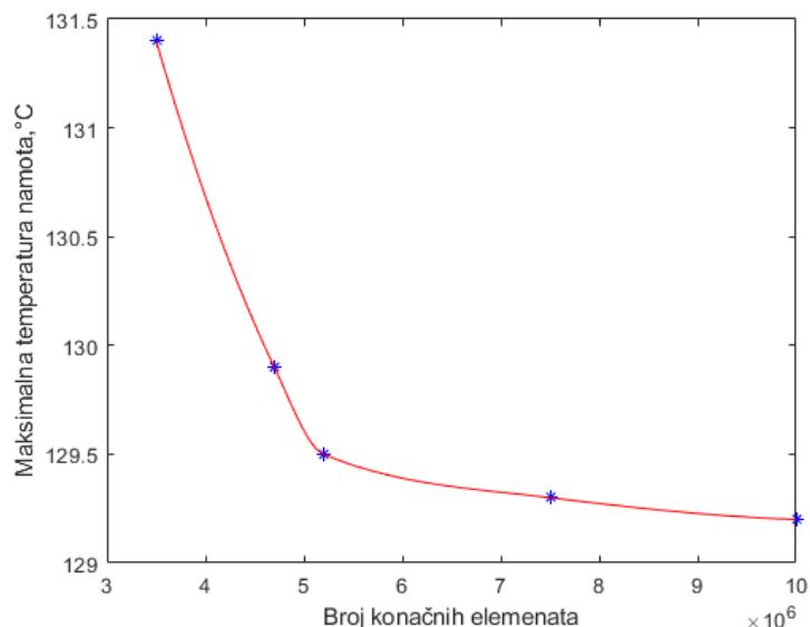
Slika 26. Konvergencija temperature u ovisnosti o broju konačnim elemenata
