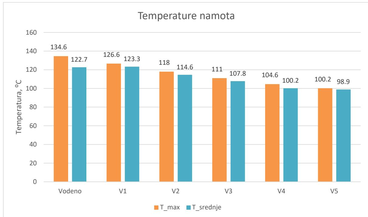
Slika 63. Usporedba temperatura namota za 15 L/min
