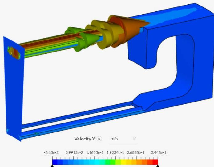
**Slika 40. Brzina protoka u aksijalnom smjeru – V1, 15 L/min**
