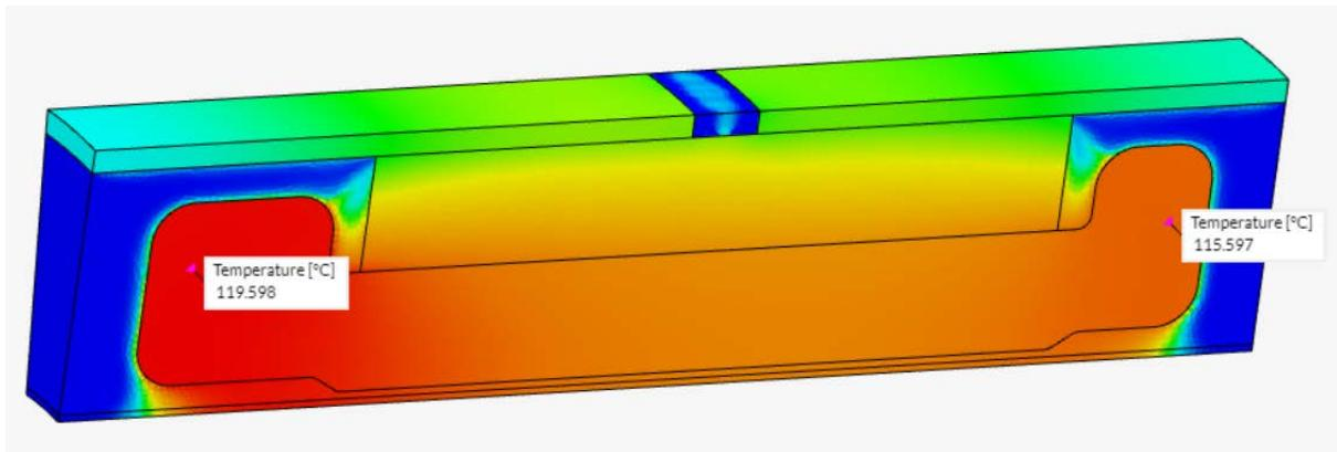
Slika 52. Temperature u namotima za modificiranu V3
