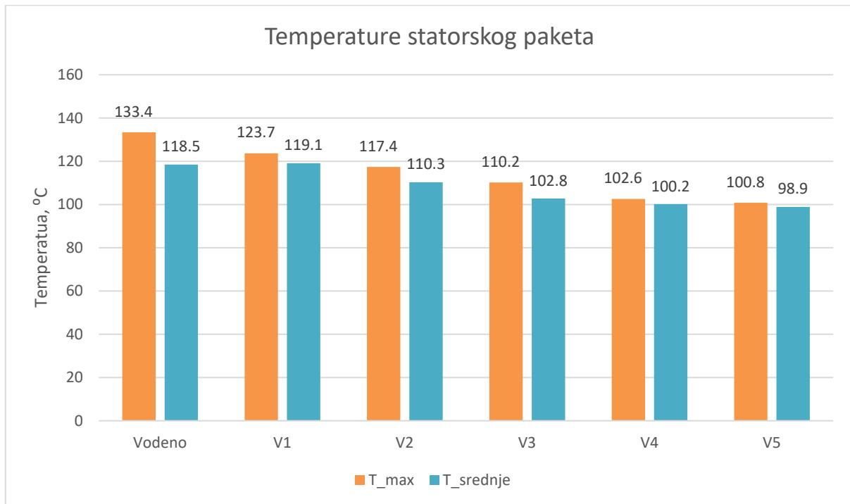
**Slika 65.** Usporedba temperatura statorskog paketa za 15 L/min
