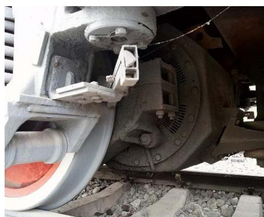
**Slika 16. Primjeri motora hlađenih zrakom**
