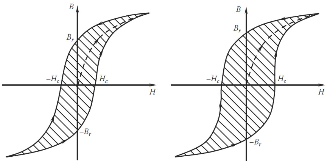
**Slika 13. Krivulja histereze – 'meki' magnetski materijal (lijevo), 'tvrdi' magnetski materijal (desno) [5]**
