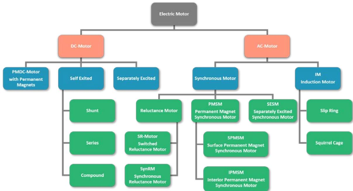
Slika 2. Vrste elektromotora [3]
