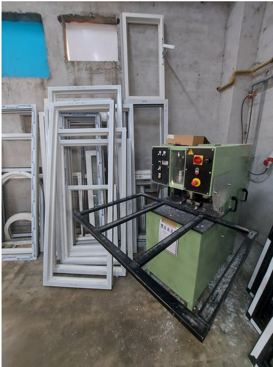
Slika 4. Stroj za uklanjanje nakupina plastike nakon zavarivanja
