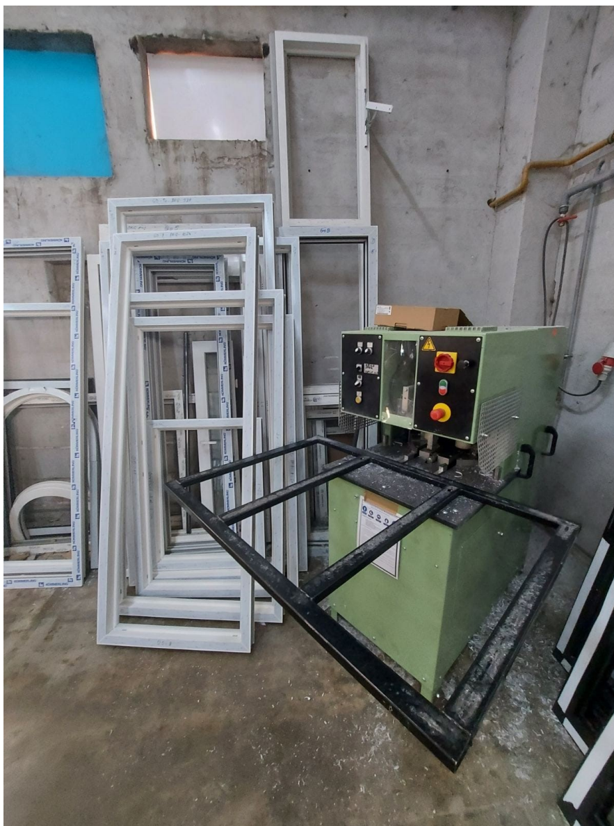
Slika 4. Stroj za uklanjanje nakupina plastike nakon zavarivanja
