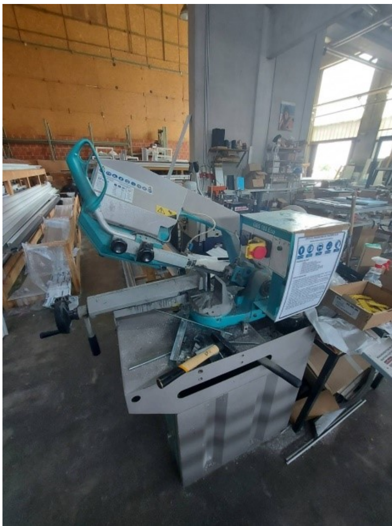
Slika 3. Pila za rezanje čeličnih profila
