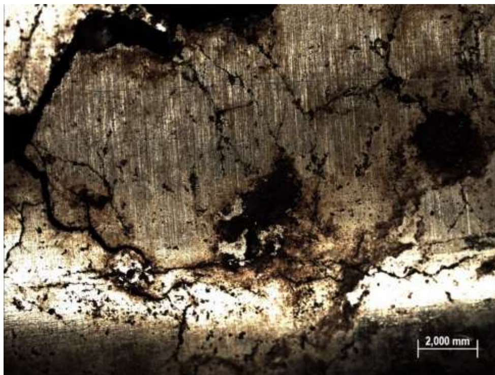
Slika 57. Otvorena pukotina na vanjskoj površini cijevi.
