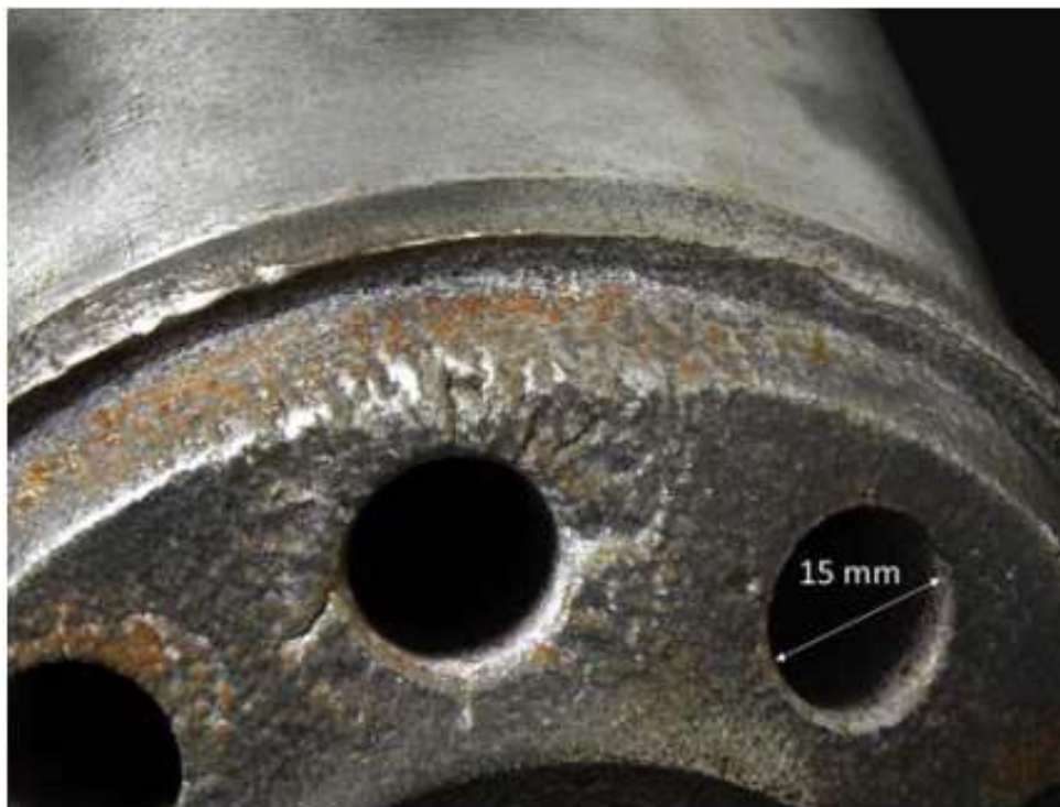
Slika 30. Površinska interkristalna korozija nastala zbog senzibilizacije [18].
