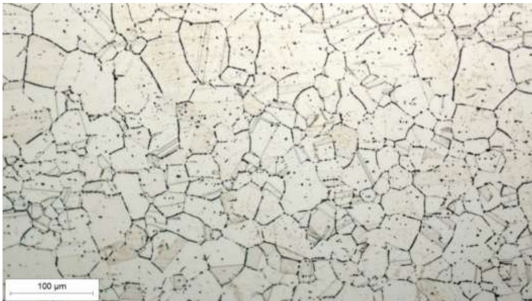
Slika 69. Austenitna mikrostruktura čelika EN 1.4301 (AISI 304).
