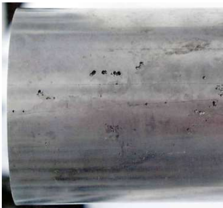
Slika 21. Jamičasta korozija na vanjskoj površini cijevi [1].
