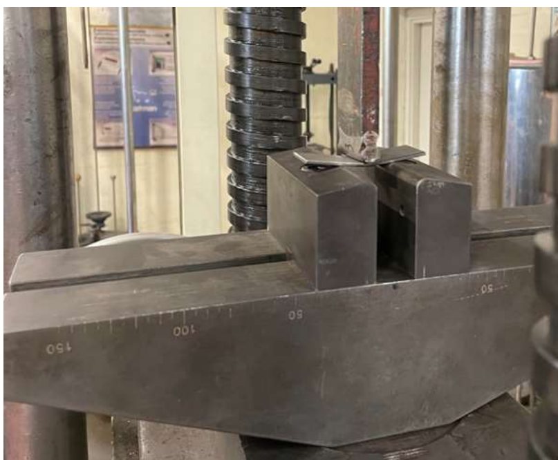
Slika 89. Savijanje uzorka na savijačici s trnom.
