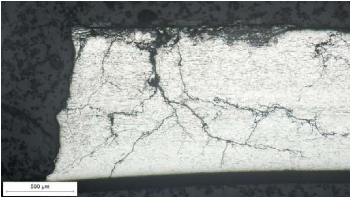
Slika 73. Razgranata pukotina u čeliku EN 1.4301 (AISI 304).
