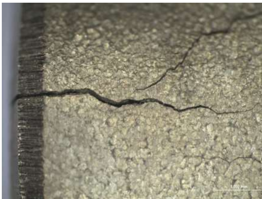
Slika 98. Pukotina na vanjskoj površini luka uzorka od čelika EN 1.4362 (AISI 2304).
