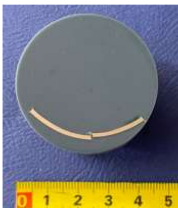
Slika 62. Uzorak za ispitivanje poprečnog presjeka cijevi.
