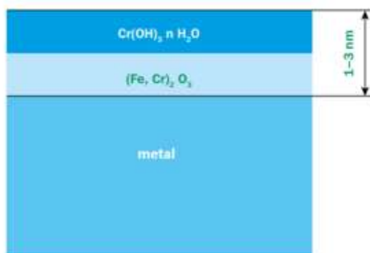
Slika 20. Prikaz pasivnog sloja na nehrđajućem čeliku [1].
