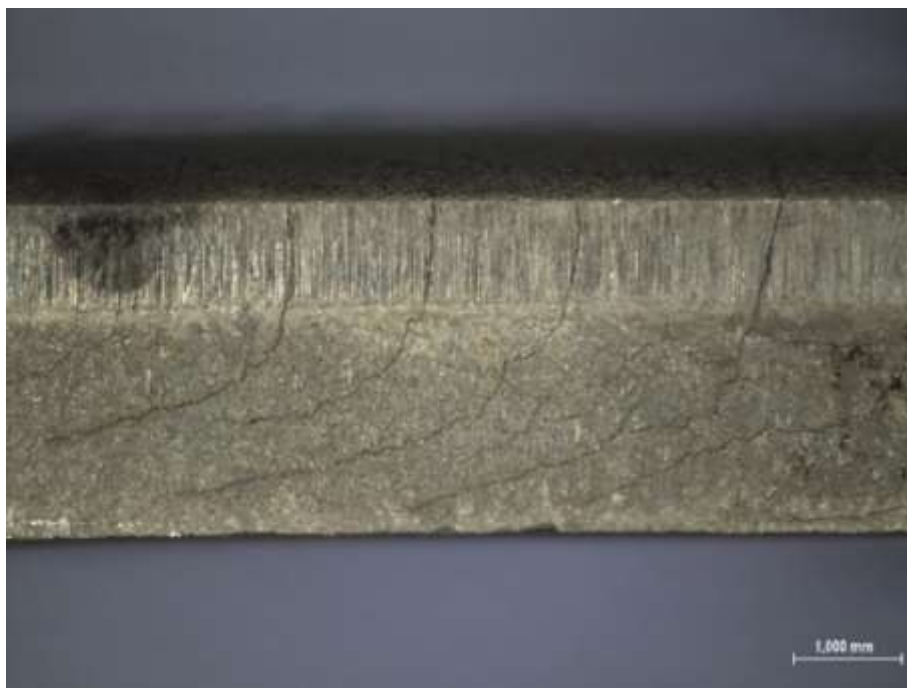
Slika 95. Paralelne pukotine propagiraju od vanjske prema unutarnjoj površini uzorka od čelika EN 1.4301 (AISI 304).
