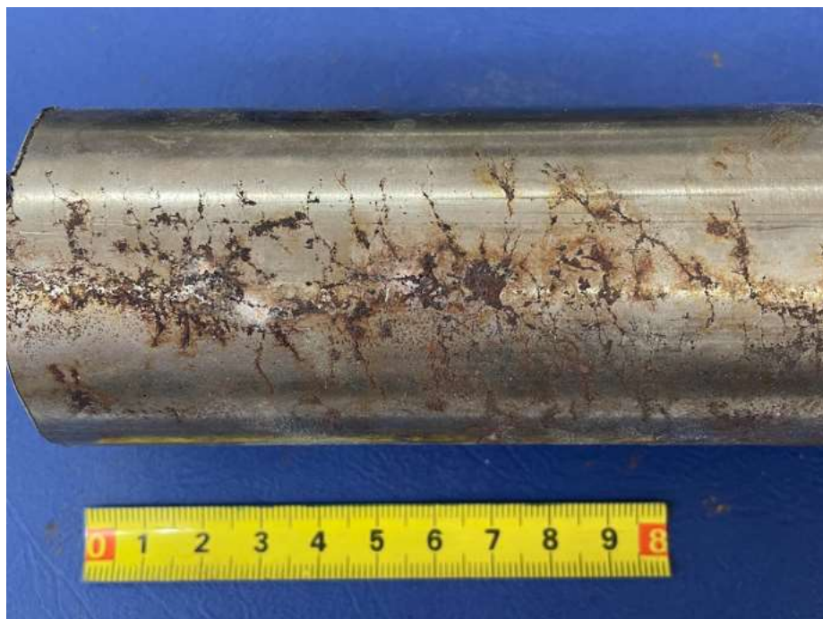
Slika 52. Brojne pukotine i korozijski produkt na vanjskoj površini cijevi.
