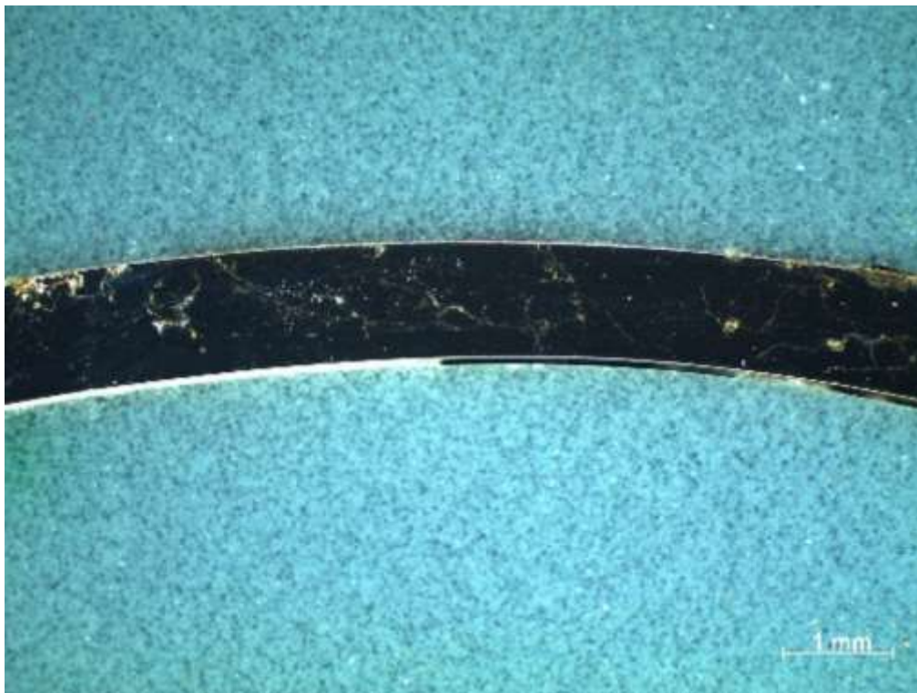
Slika 63. Pukotine na poprečnom presjeku cijevi.
