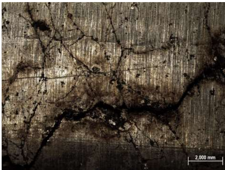
Slika 56. Otvorena pukotina na vanjskoj površini cijevi.
