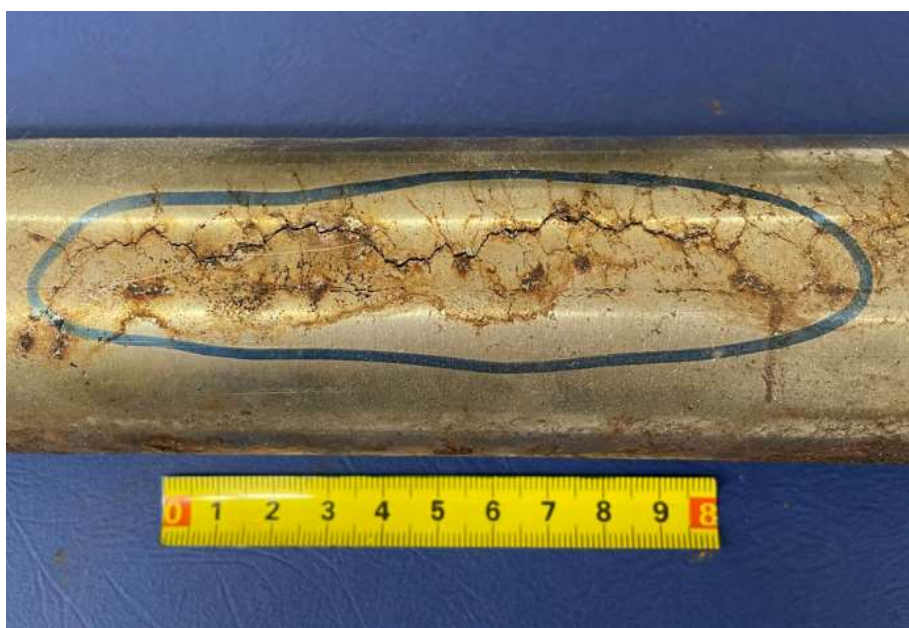
Slika 53. Otvorena pukotina na vanjskoj površini cijevi.
