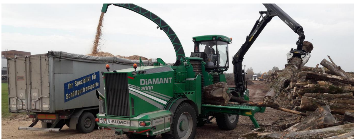
Slika 2. „Albach Diamant 2000“ mobilni sječač [1]
