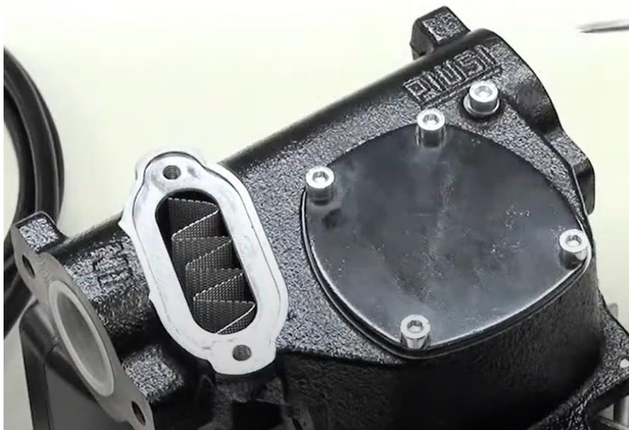
Slika 6. Mrežasti filter u usisnom dijelu crpke [5]
