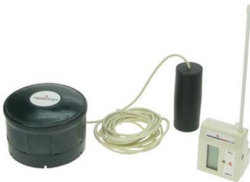
Slika 11. Alarm propuštanja i senzor razine [9]
