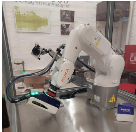
Slika 42. Uređaj za mjerenje zaostalih naprezanja
