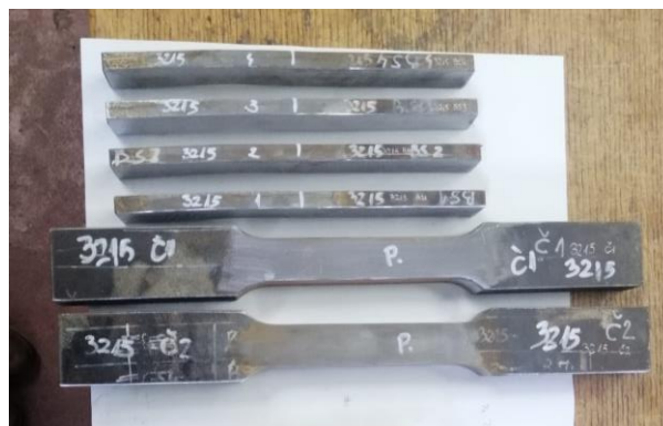
Slika 27. Epruvete dobivene rezanjem vodenim mlazom
