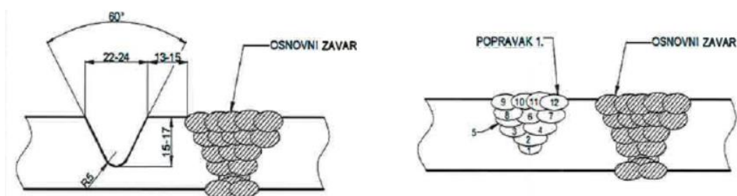
Slika 24. Shematski prikaz prvog popravka
