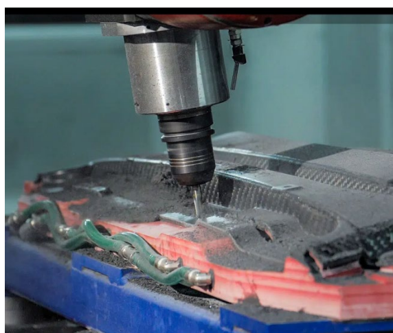
Slika 3.4 Obrezivanja karbona na pet osnom glodačkom obradnom centru [11]
