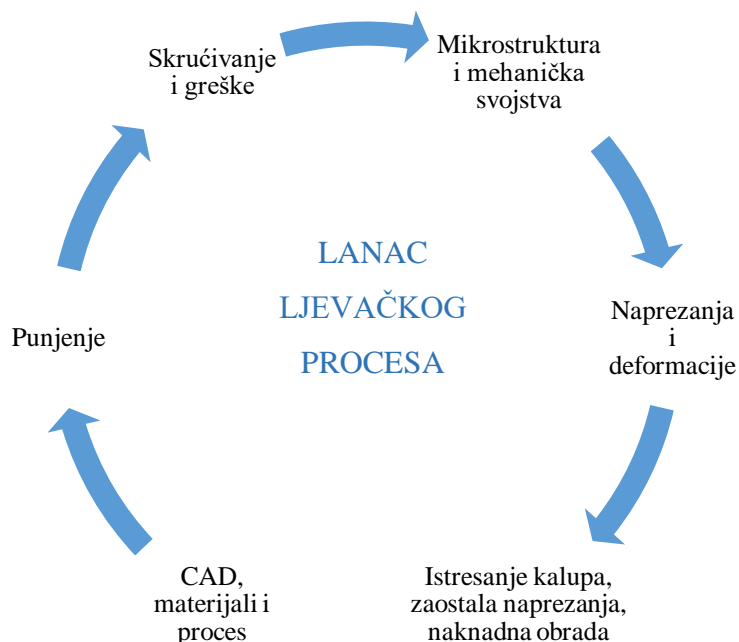
Slika 23. Lanac ljevačkog procesa [13]
