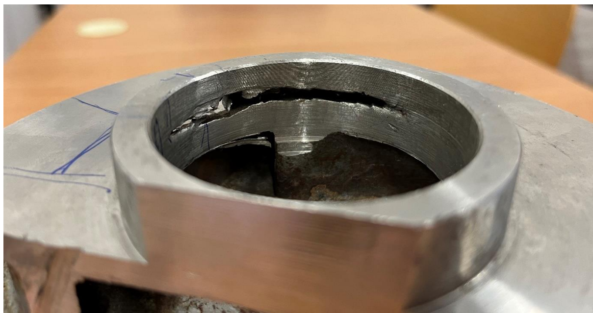
Slika 27. Greške na odljevku, veće povećanje
