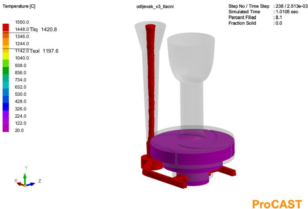
Slika 59. Punjenje kalupne šupljine nakon 1 sekunde
