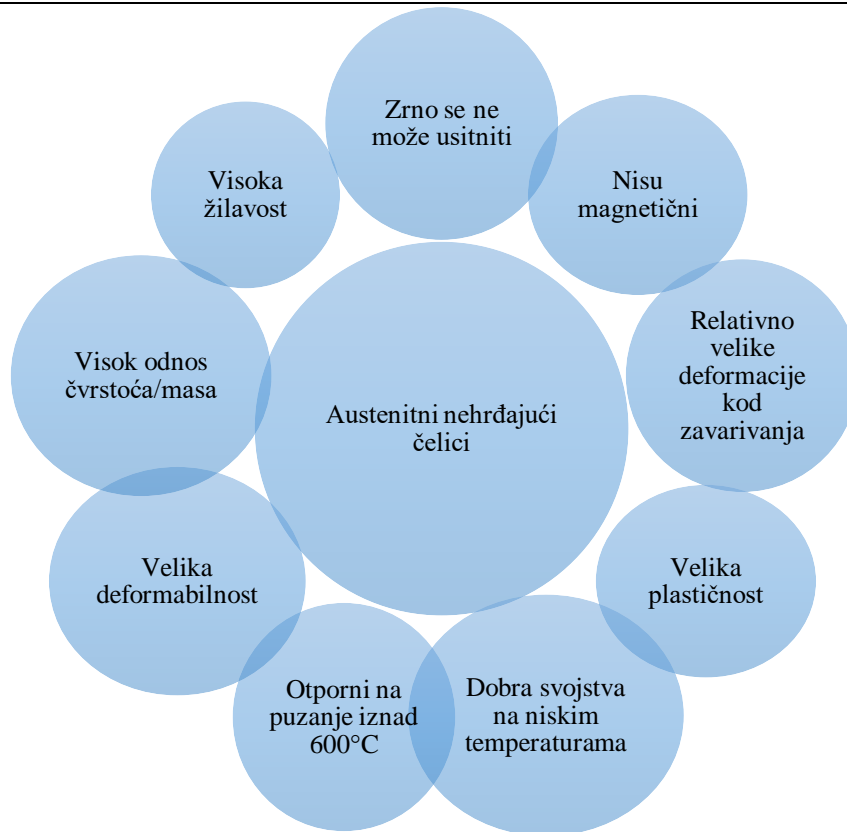
Slika 5. Svojstva austenitnih nehrđajućih čelika [4]
