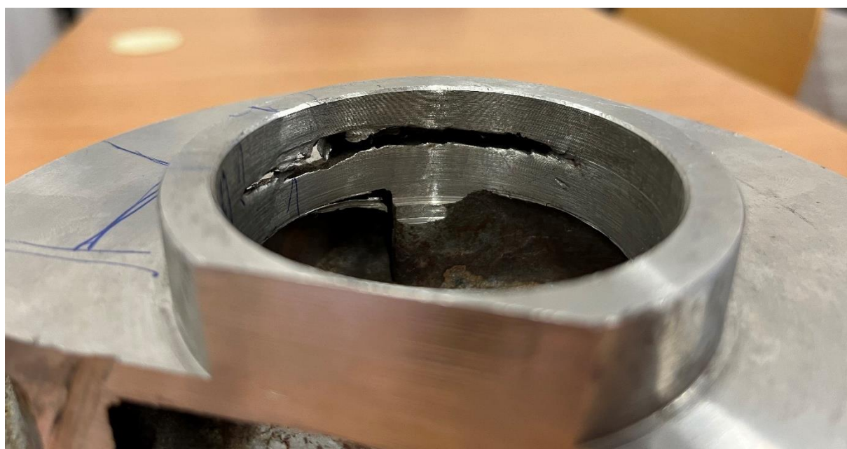
Slika 27. Greške na odljevku, veće povećanje
