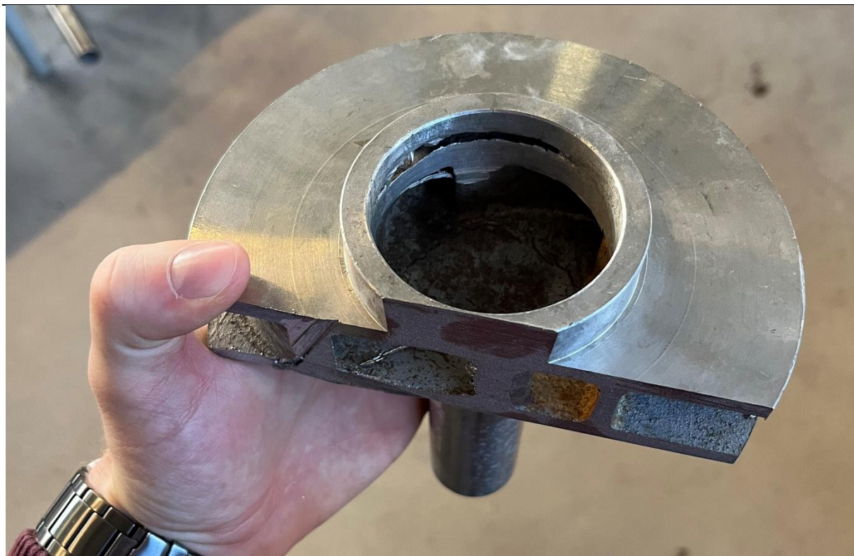
Slika 26. Greške na odljevku
