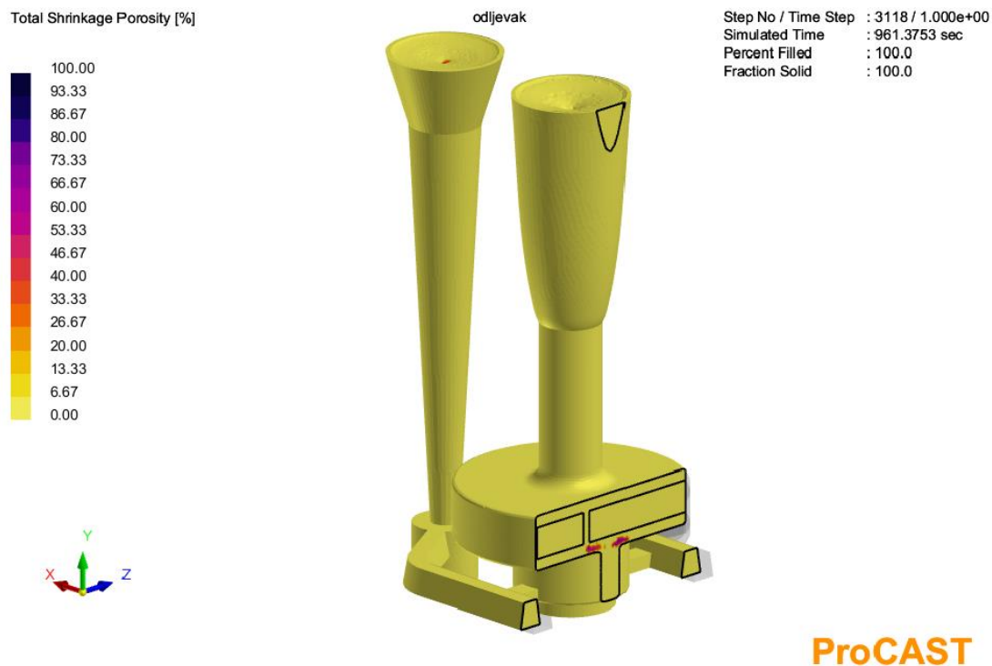
Slika 47. Vjerojatnost nastanka poroznosti u poprečnom presjeku 1
