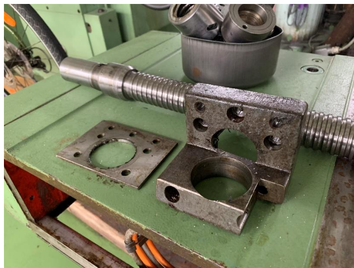
Slika 39. Nosač gornjeg radijalnog ležaja Z osi
