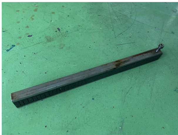
Slika 44. Polimerna masa na klinu za regulaciju zračnosti vodilica
