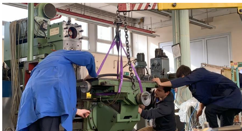
Slika 37. Demontaža stola glodalice
