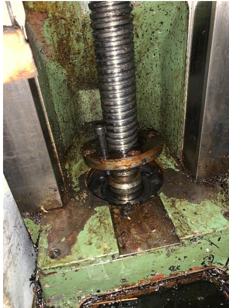
Slika 38. Prsten za prednaprezanje ležajeva u reduktoru
